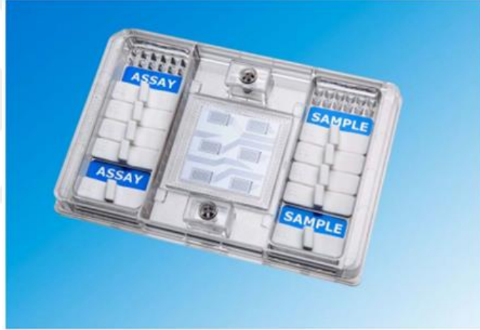
Şekil 3.1. 12x12’lik FlexSix çip
