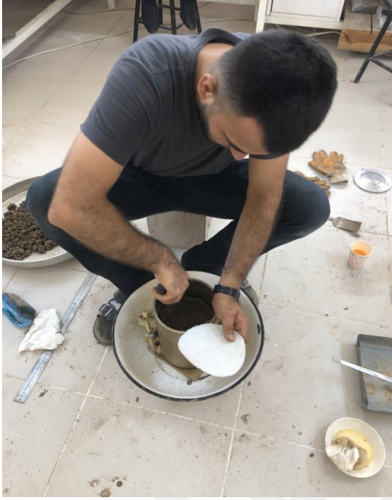
(a) CBR kalıbı içersine kenevir donatı yerleştirilmesi
