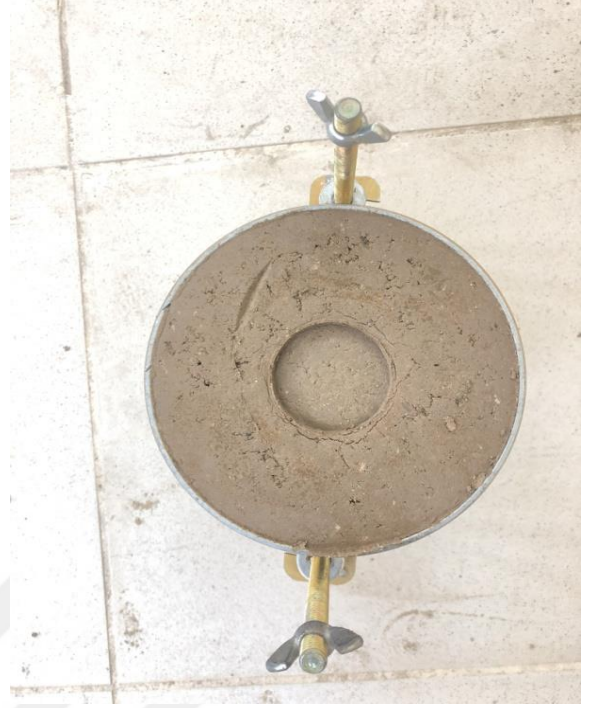
(b) CBR deneyi sonrasında zemine, pistonun batma izi
