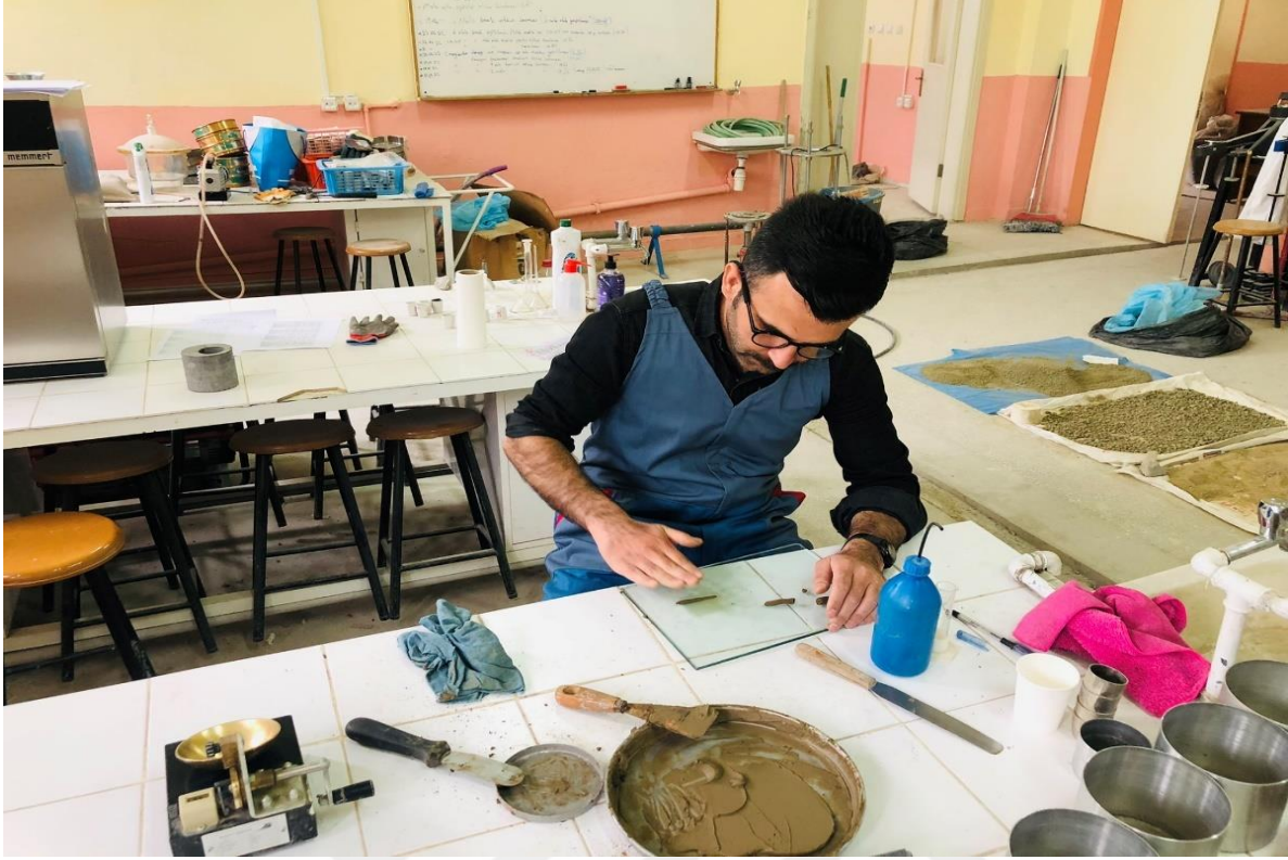
Resim 3.14. Cam levha ile plastik limit değerin belirlenmesi.
