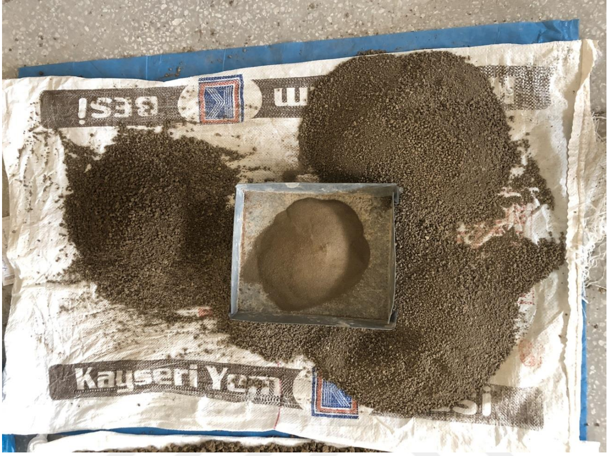
Resim 3.12. Likit limit ve plastik limit tayini için 40 nolu elekten elenmiş örnekler.
