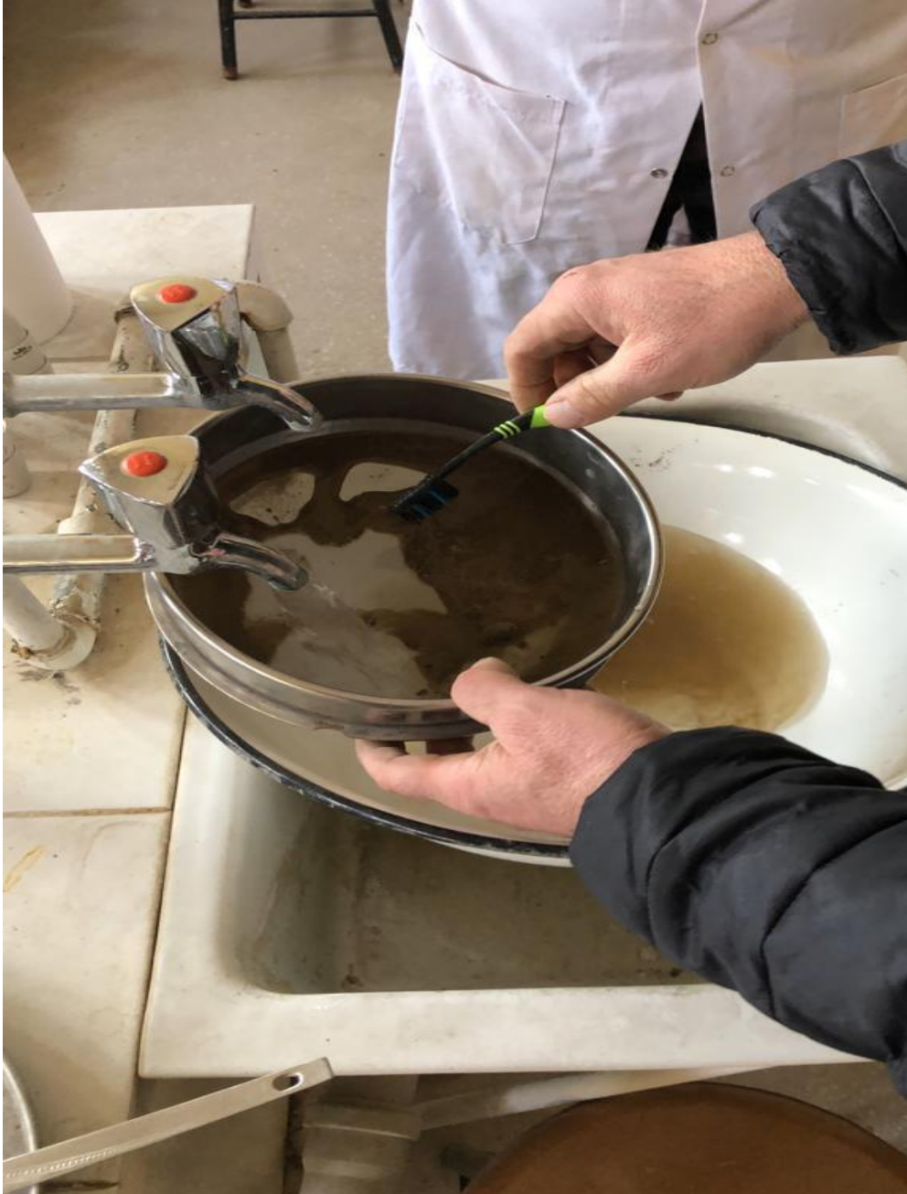
Resim 3.10. İnce taneli zemin miktarının ıslak eleme yöntemiyle belirlenmesi.
