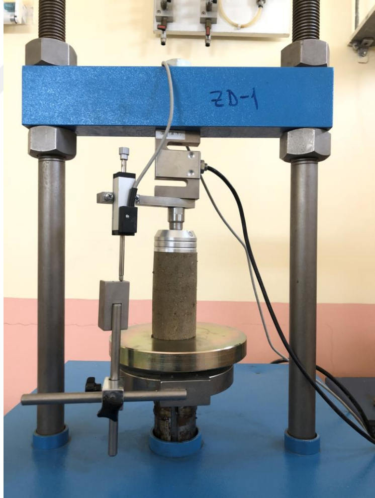
Resim 3.18. Serbest basınç deneyinin uygulanması.
