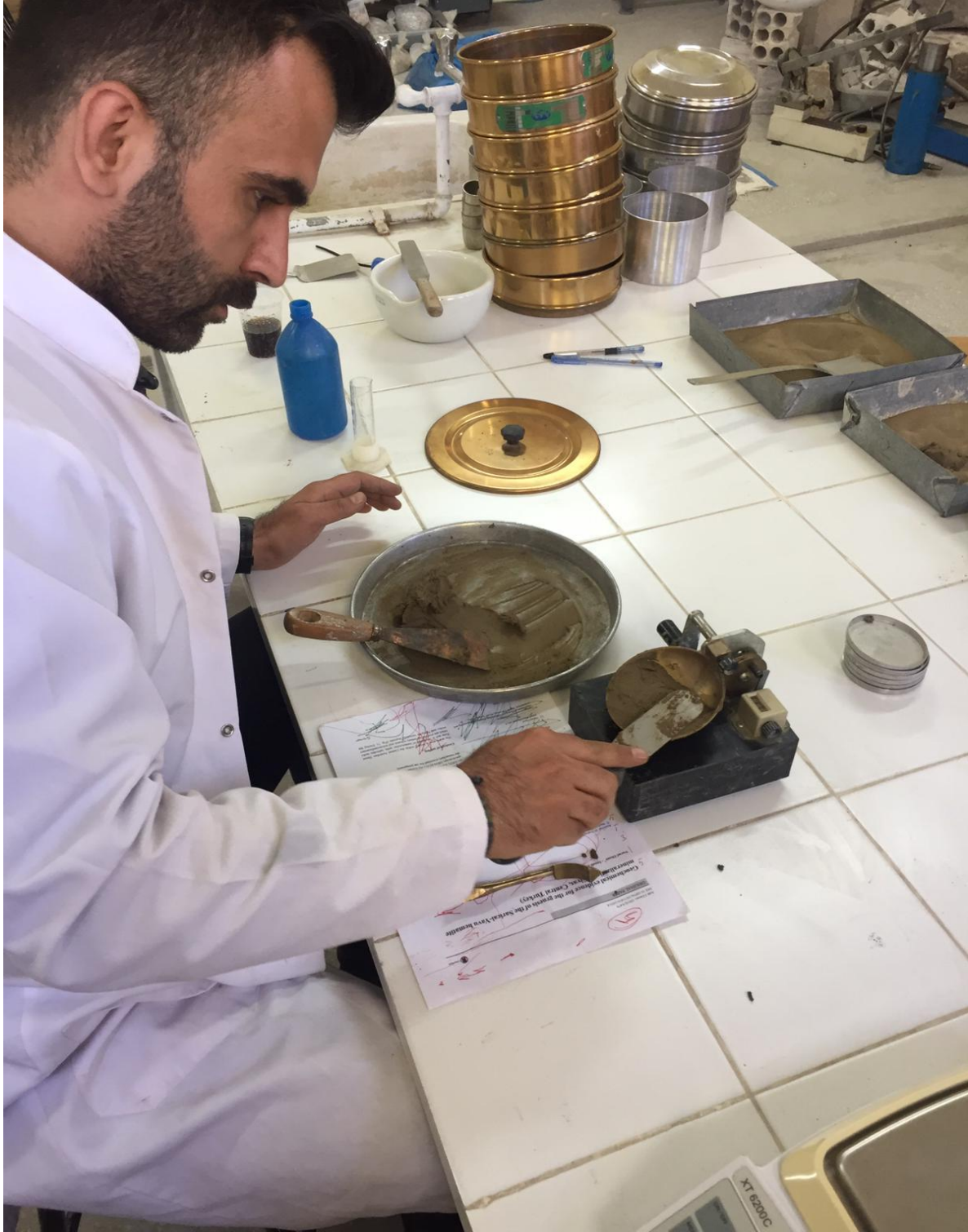
Resim 3.13. Casagrande cihazı ile zeminlerin likit limit değerin belirlenmesi.
