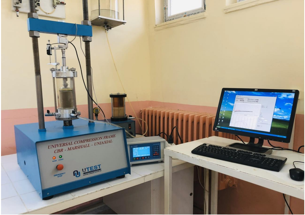
Resim 3.19. Üç eksenli basınç deneyinin uygulanması.
