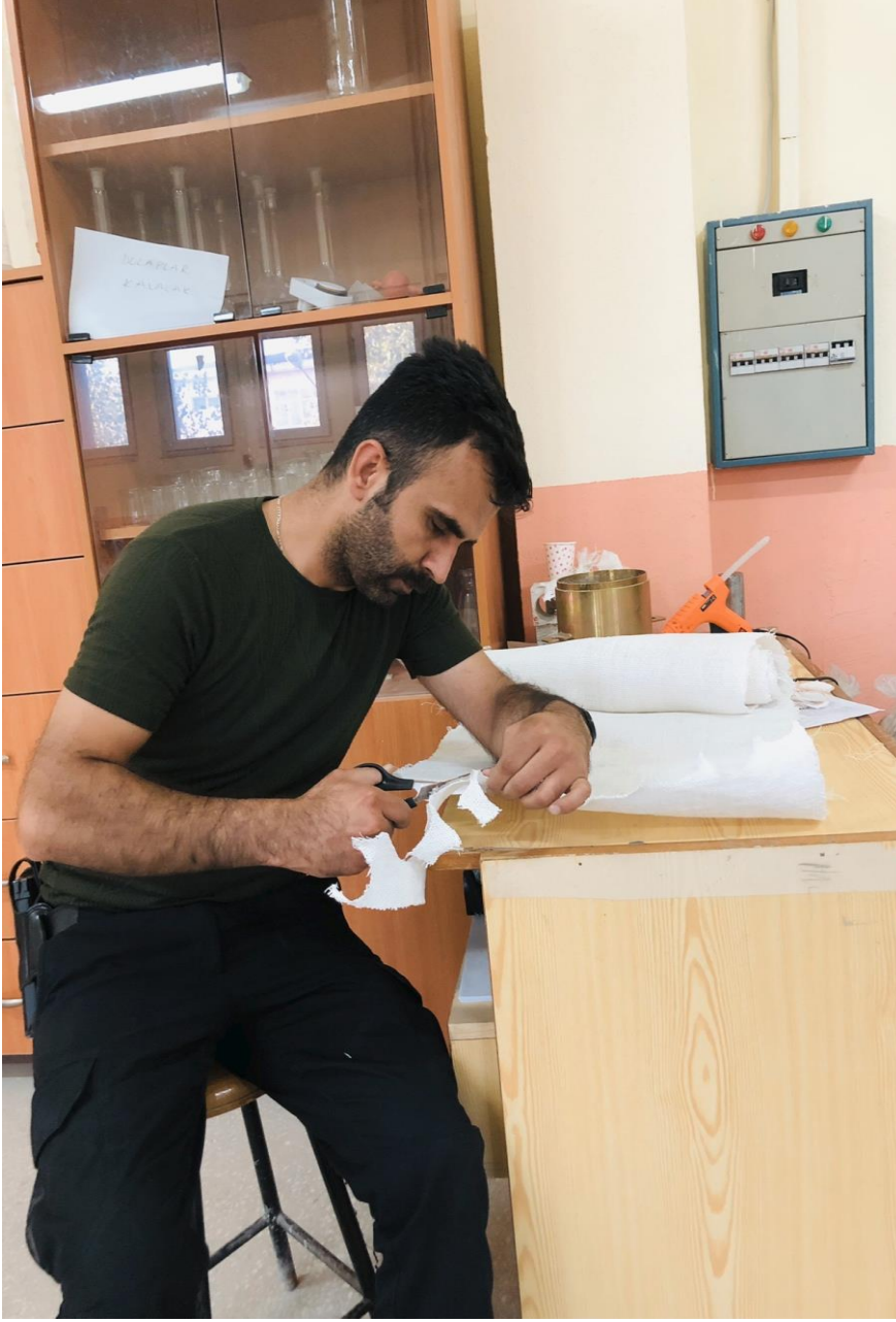
Resim 3.6. Sıkıştırılacak deney örneklerinin içine yerleştirilecek dairesel kenevir kumaş parçalarının hazırlanması.
