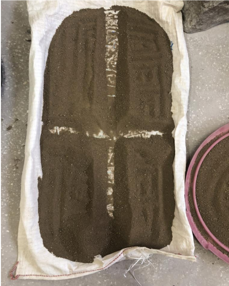
Resim 3.3. Çeyrekleme yöntemiyle örnek miktarının azaltılması.
