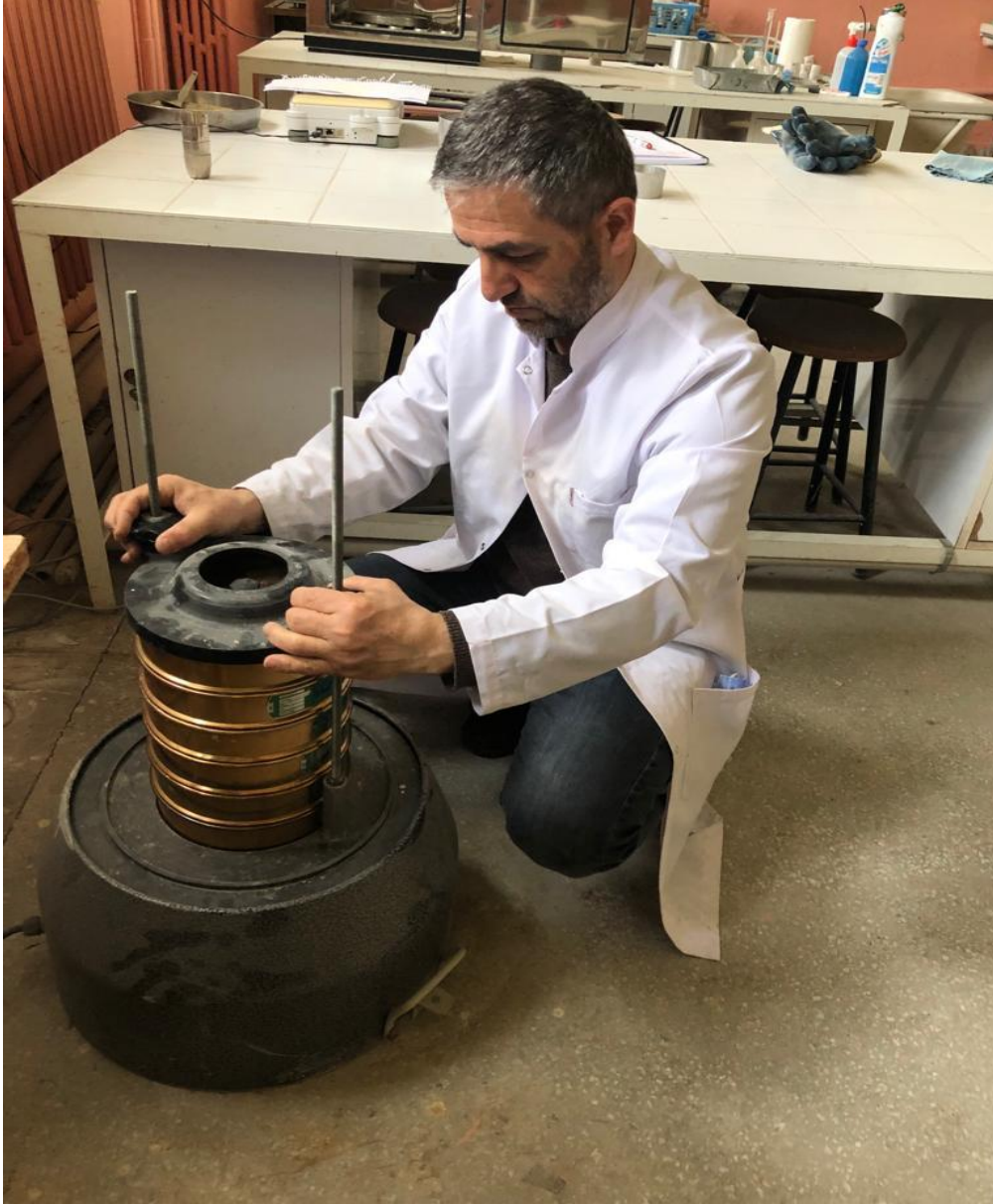
Resim 3.11. İri taneli zeminlerin tane boyu dağılımının kuru elek tekniği ile belirlenmesi.
