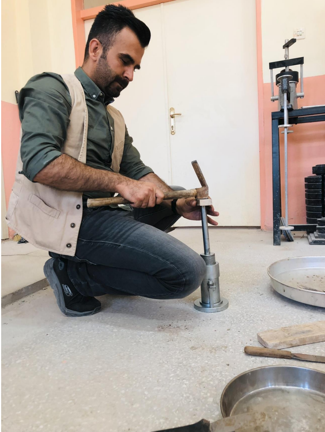
Resim 3.16. Serbest basınç deneyi için kalıp içinde sıkıştırılmış örneklerin hazırlanması.
