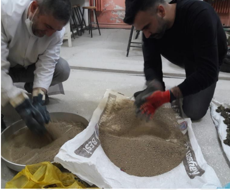
Resim 3.2. Araziden alınan örneklerin 4 nolu elekten elenerek çalışmaya hazır hale getirilmesi.
