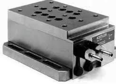
Şekil 3.5. KISLER 9257 B tipi dinamometre (Boy,2004)
