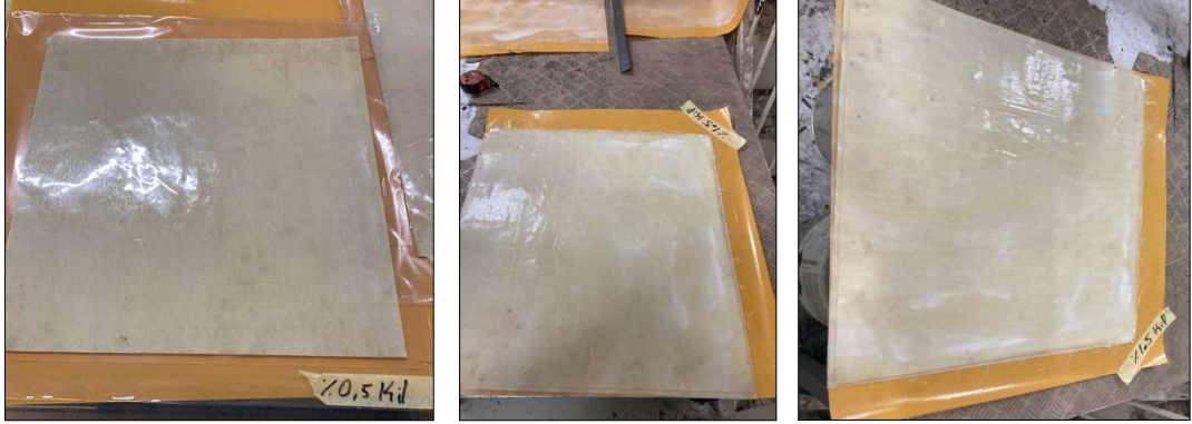
Şekil 5.10 Üretilen tabakaların sıcak pres için yanmaz jelatinle kaplanması
