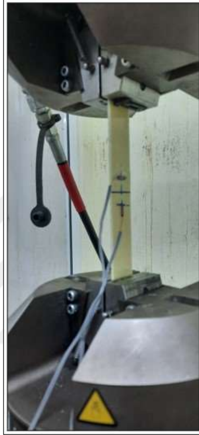
Şekil 5.14 Instron marka test cihazı ve çekme testinin yapılışı
