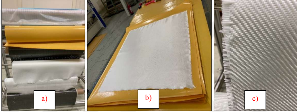
Şekil 5.6 Fiber kumaşın seçimi, a) Rulodan kumaşın kesilmesi, b) Kumaş geometrisi, c) Örgü tipi
