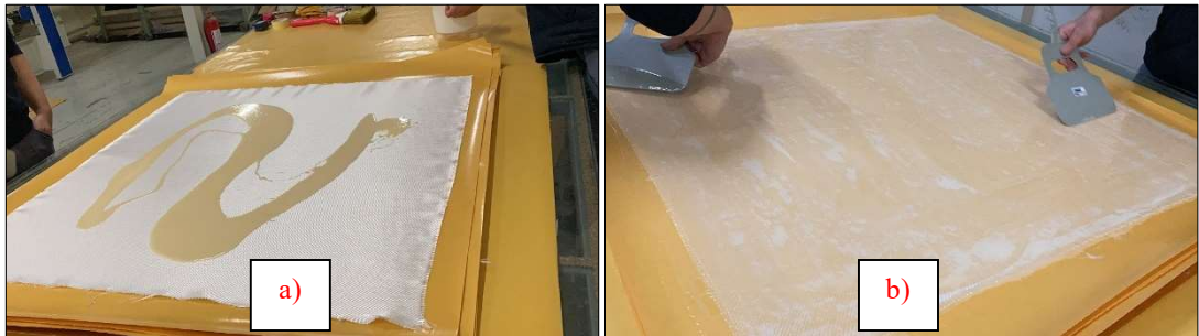
Şekil 5.7 Elle yatırma yöntemi ile kompozitin üretimi, a) Reçinenin kumaşa dökülmesi, b) Reçinenin kumaşa emdirilmesi
