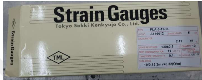
Şekil 5.15 Kullanılan strain-gauge özellikleri
