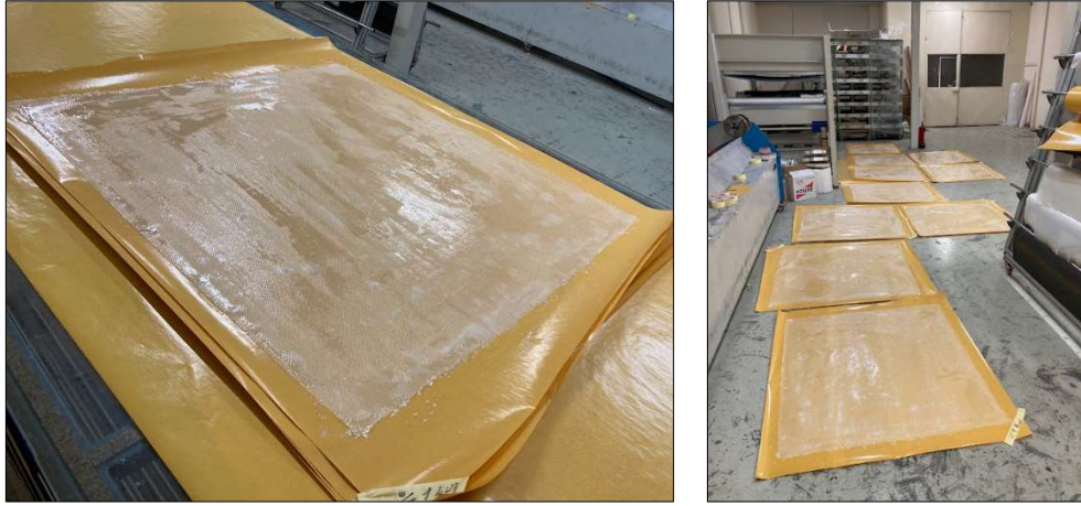
Şekil 5.8 Reçine emdirilmiş takviye malzemesinin kurumaya bırakılması
