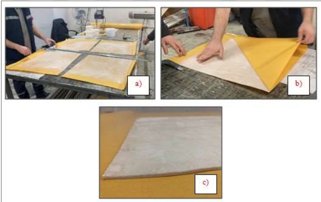
Şekil 5.9 Tabakaların üretimi, a) Kumaşın uygun ölçülerde kesimi, b) Kesilen parçaların birleştirilmesi, c) Birleştirilen tabakaların son hali
