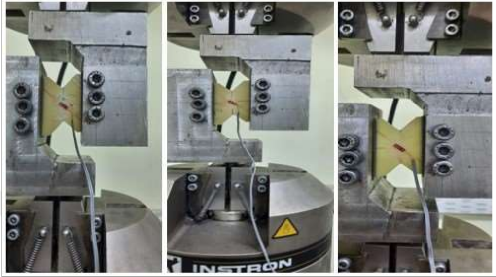
Şekil 5.22 Instron marka test cihazı ile kayma testinin yapılışı
