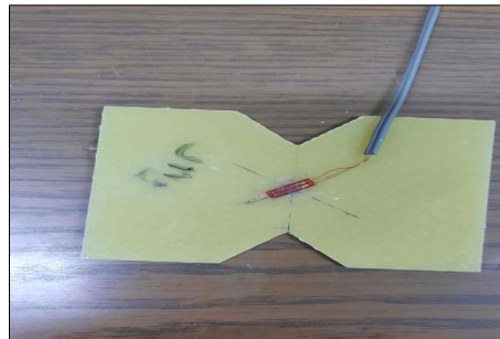
Şekil 5.21 Kayma testi numunesi strain gauge bağlantısı
