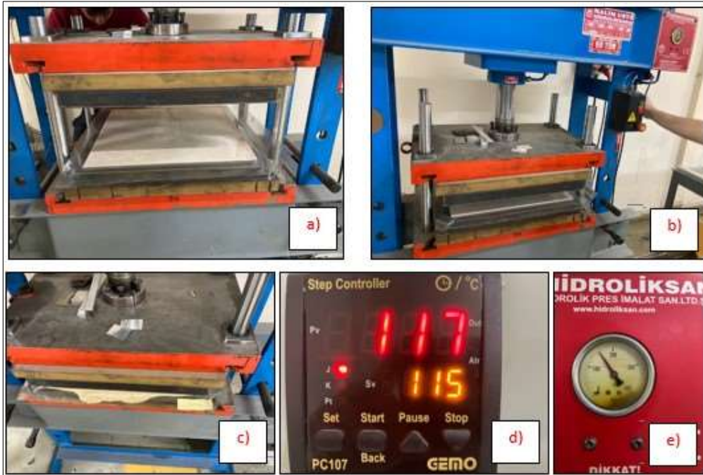
Şekil 5.11 Plaklara sıcak pres uygulanması, a) Birleştirilen tabakaların prese yerleştirilmesi, b) Kalınlık plakasının yerleştirilmesi, c) Sıcak presin uygulanması, d) Kontrol paneli, e) Manometre
