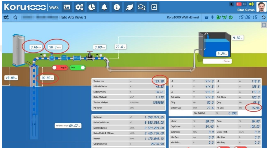
Şekil 4.20 Uygulama Kuyusu -1: Debi 90.3 m 3 /h, Hm 123.6 m ve P1 Enerji Tüketimi 75.9 kWh
