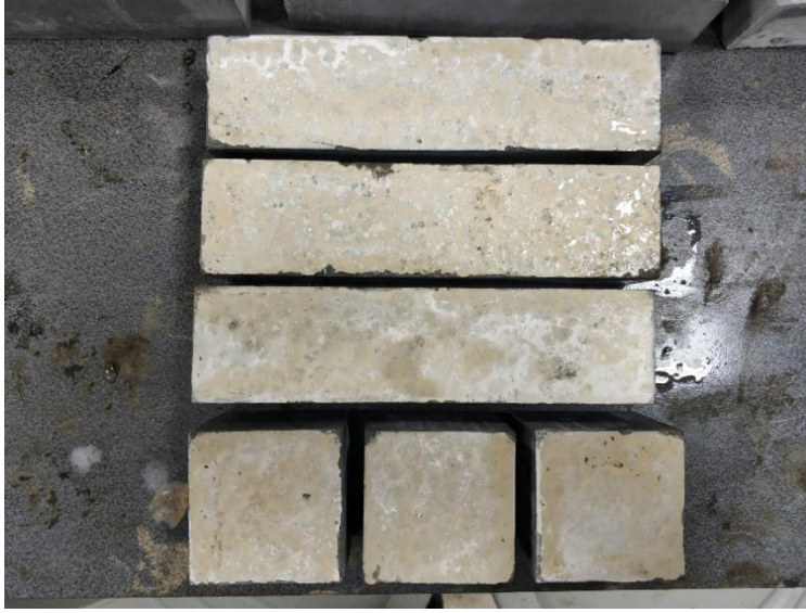
Şekil 4.3. F4 kodlu AÇH numunesinde yaşanan kuma olayı
