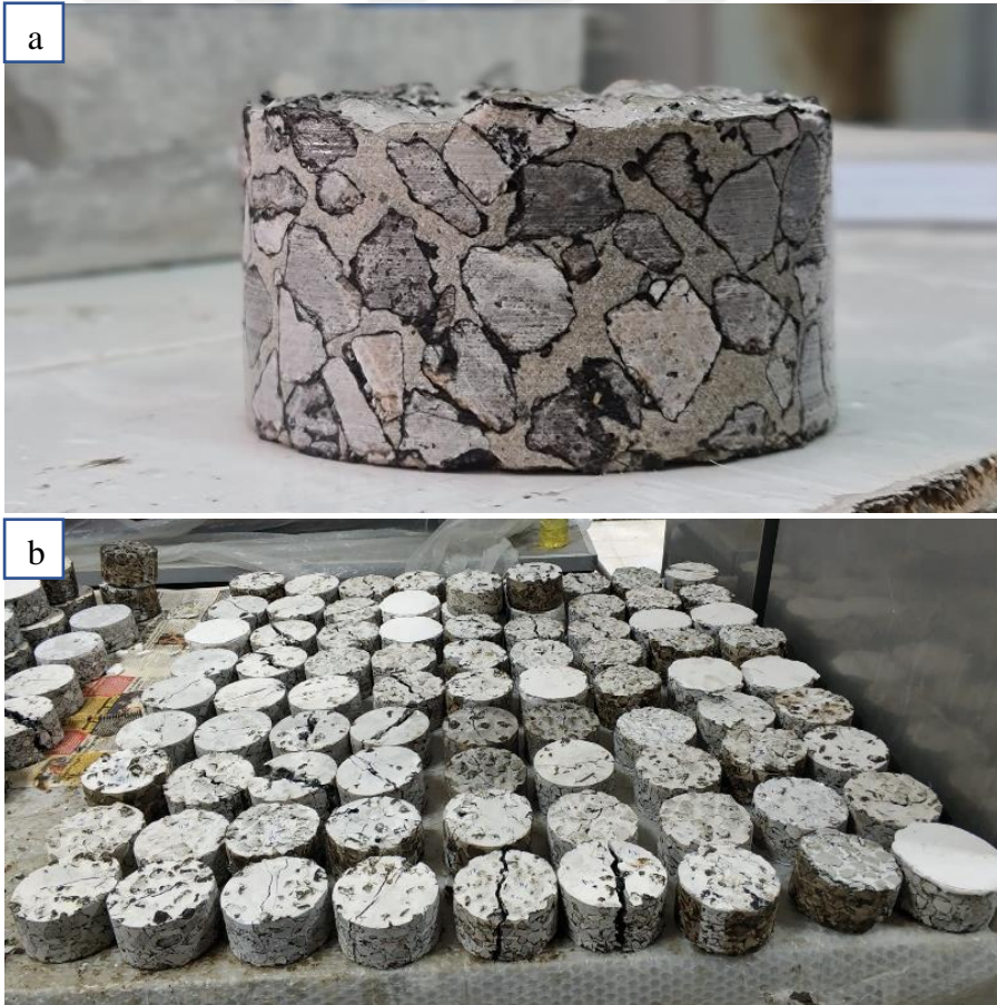
Şekil 3.39. a) YRK karot numunesi; b) Performans testlerine tabi tutulmuş YRK numuneleri
