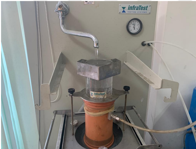
Şekil 3.36. Düşey permeabilite deneyi
