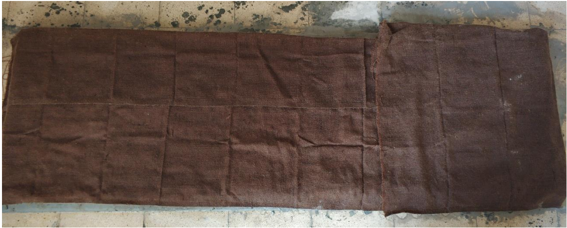
Şekil 3.28. Islak jüt beziyle YRK'lerin kürlenmesi
