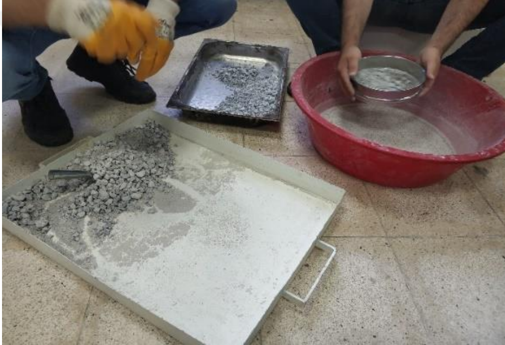
Şekil 3.7. Agregaların 12 No'lu elekte elenmesi
