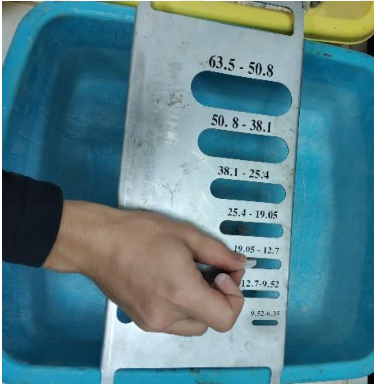
Şekil 3.8. Yassılık indeksi şablonu ve deneyin yapılışı
