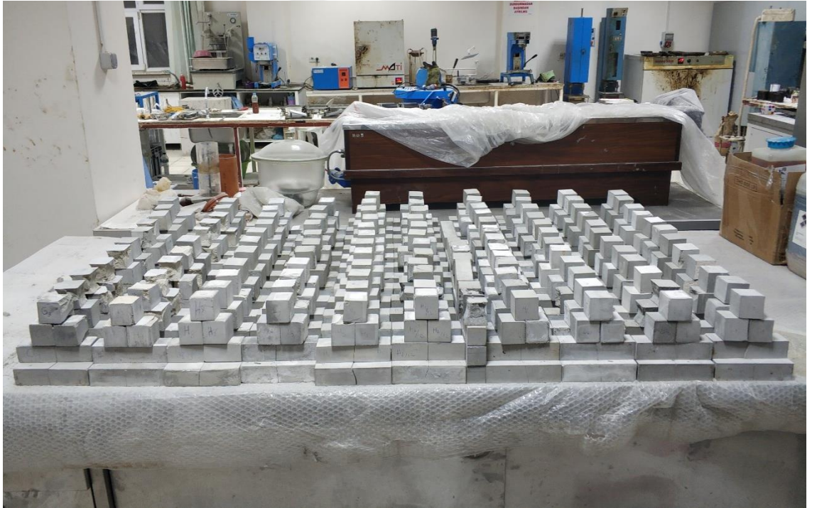
Şekil 3.22. Basınç ve eğilme dayanımı deneyleri sonucu kırılan numuneler
