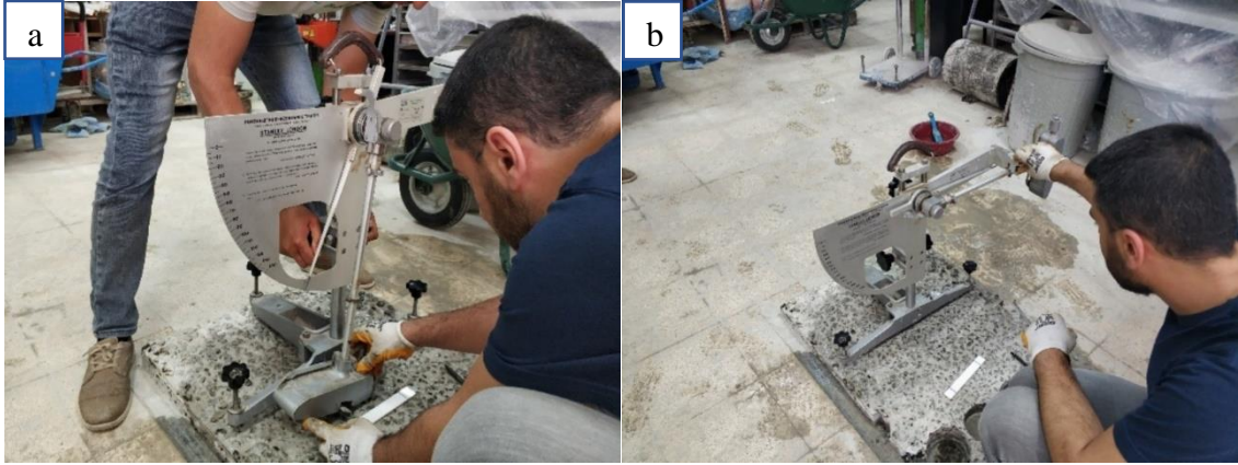
Şekil 3.38. a) Sarkacın ayarlanması; b) Sarkacın serbest bırakılması
