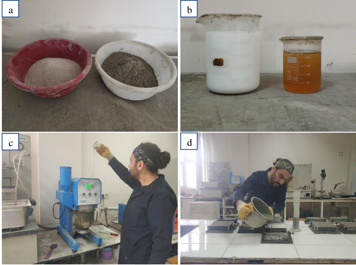
Şekil 3.18. a) Agrega ve çimento; b) Lateks+%80 su ve süper akışkanlaştırıcı+priz hızlandırıcı+%20 su; c) Miksere katkılı suyun eklenmesi; d) AÇH'nin kalıplara dökülmesi
