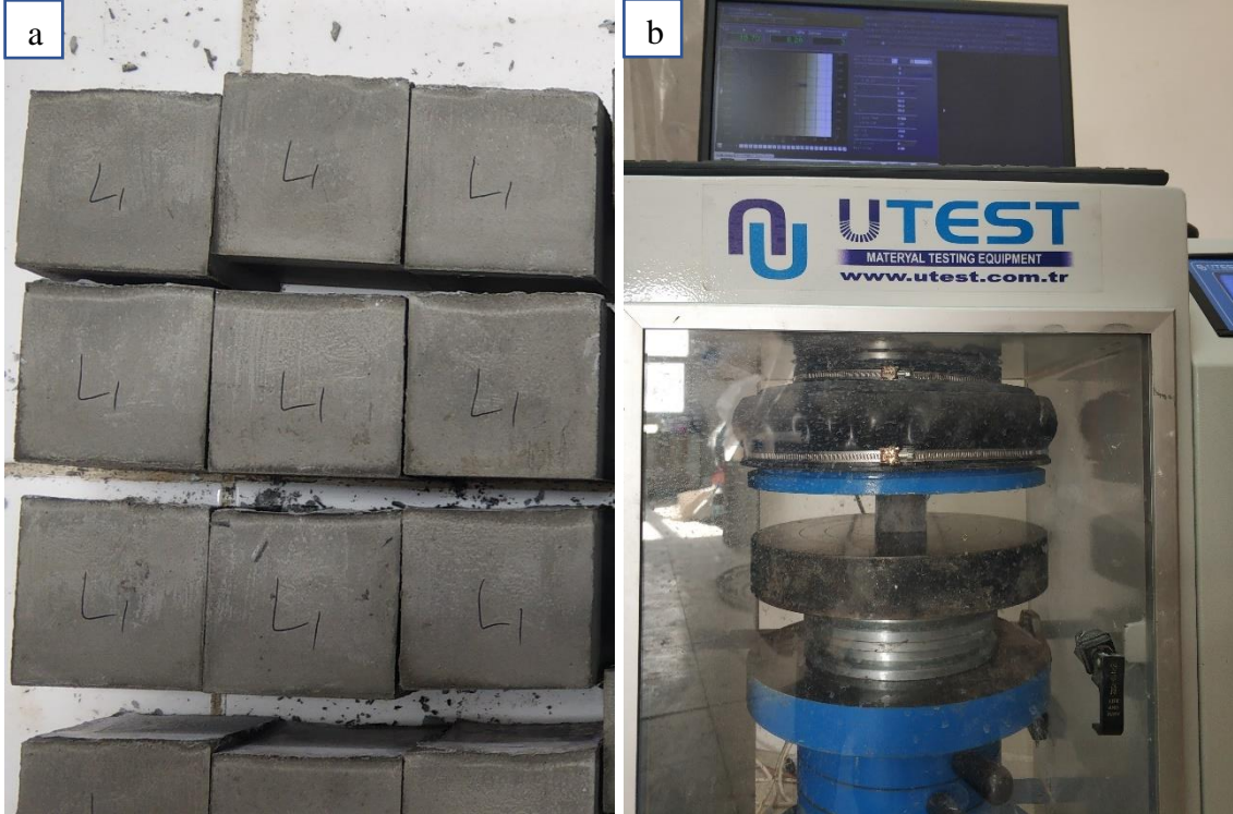
Şekil 3.20. a) 50 \text{ mm}^3 ’lük numuneler; b) Basınç dayanımı deney düzeneği
