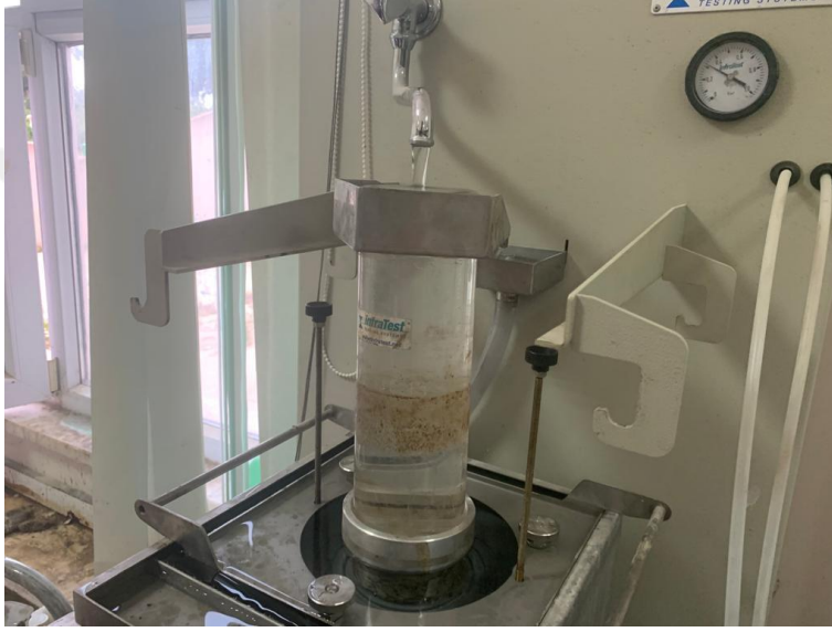
Şekil 3.37. Yatay permeabilite deneyi
