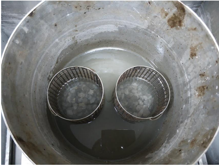
Şekil 3.12. Agregaların magnezyum sülfat çözeltisinin içerisinde bekletilmesi
