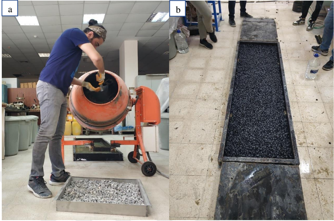
Şekil 3.25. a) Agregaların plente eklenmesi; b) Poroz asfaltın görünüşü
