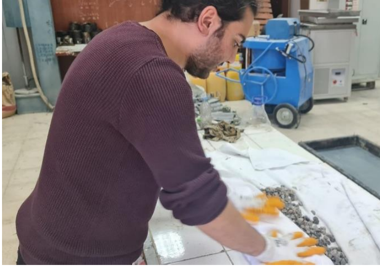
Şekil 3.4. Kaba agreganın SDKY hale getirilmesi
