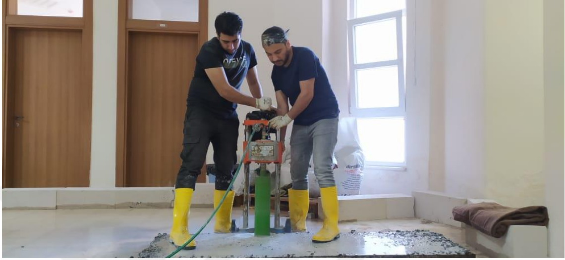
Şekil 3.27. YRK yüzeyinden karot alınması
