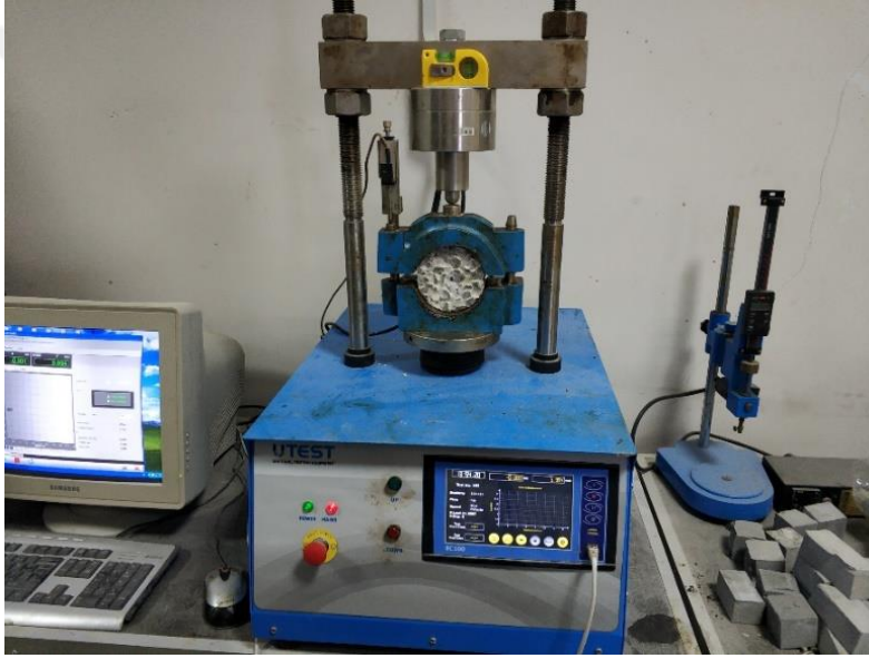
Şekil 3.29. Marshall stabilite ve akma tayini deneyi düzeniği
