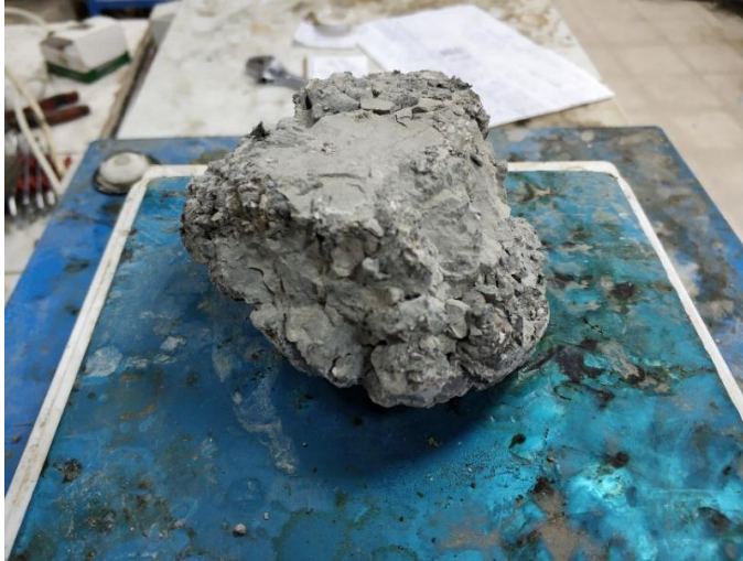
Şekil 3.33. YRK numunesinin Cantabro deneyinden sonraki görüntüsü
