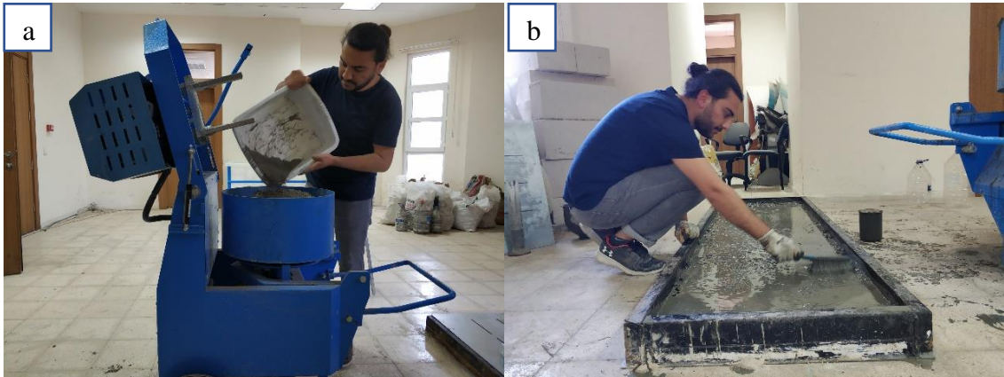
Şekil 3.26. a) Akışkan çimento harcının hazırlanması; b) Harcın poroz asfalt yüzeyinde yayılması
