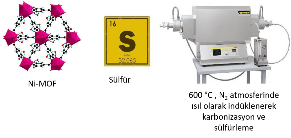
Şekil 3.4: Azot atmosferinde MOF’tan türetilmiş NiS/C fazının elde edilişi.
