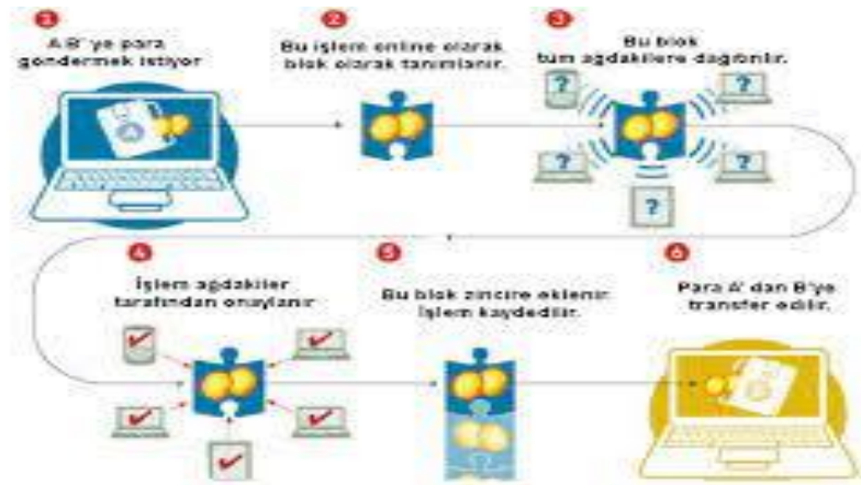
Resim 29. Blok Zincirinin Para Transferindeki Çalışma Prensipleri. 386
