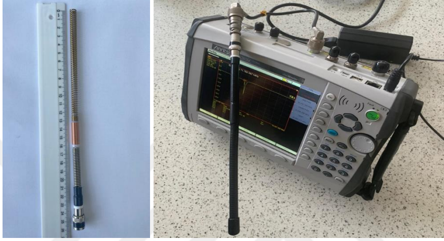
Şekil 4.29. Üretimi yapılan helisel anten fotoğrafları
