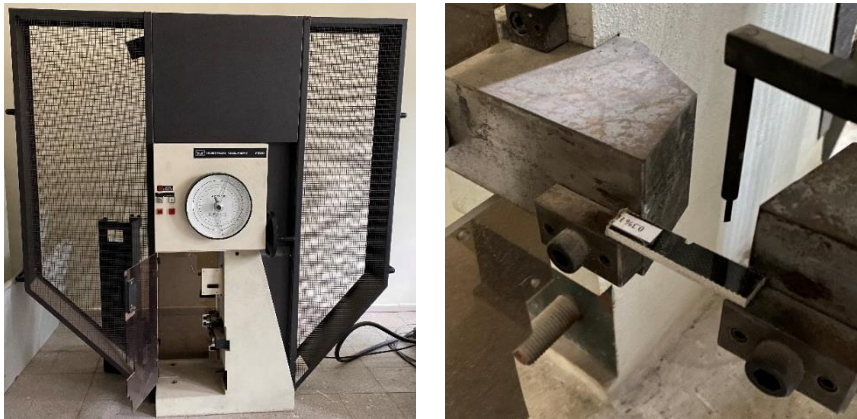
Şekil 3.18. Charpy çentik darbe test cihazı ve numunenin konumlandırılması
