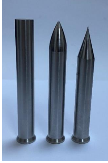
Şekil 3.20. Düz, ojiv ve konik zımbalar
