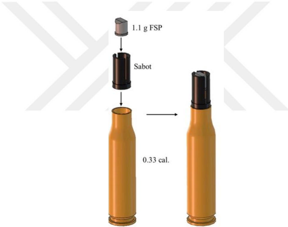
Şekil 2.25. FSP'lerin mermi kovanına yerleştirilmesi (Üstün ve diğ., 2022)
