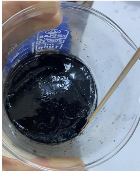
Şekil 3.8. Ultrasonik banyo esnasında kürlenmiş karışım
