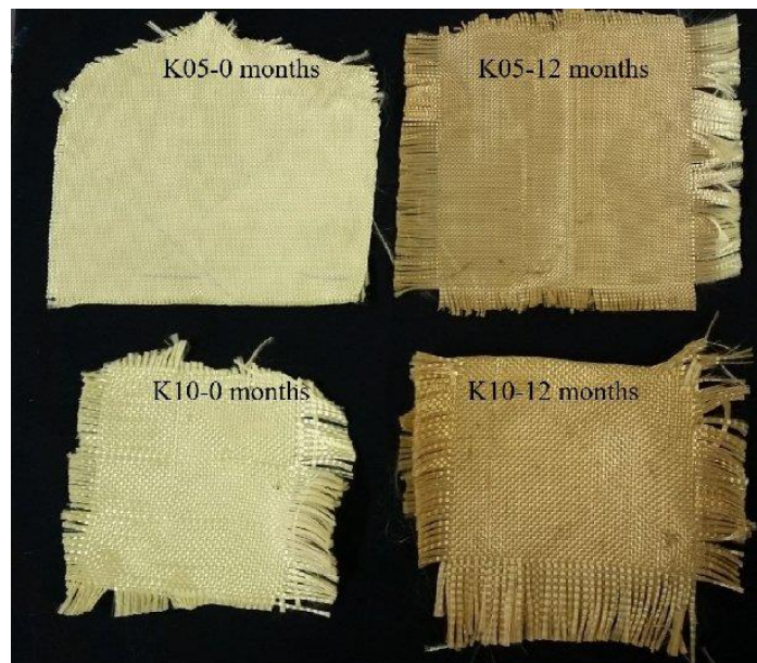
Şekil 2.21. Doğal yaşlandırma sonrası renk değiştiren aramid numuneler (Konarzewski ve diğ., 2019)
