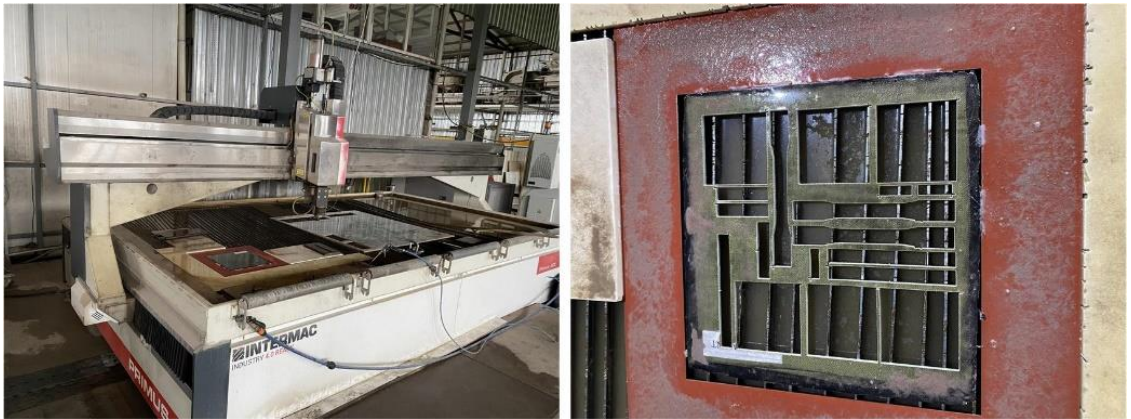
Şekil 3.12. Su jeti yardımıyla numunelerin kesilmesi
