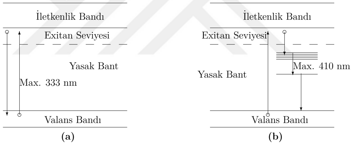
Şekil 1.11. Maksimum elektron enerji seviyesi (a) saf sodyum iyodür (NaI) sintilatörü için 333 nm ve (b) talyum (Tl) ile aktifleştirilmiş sodyum iyodür için 410 nm'dir [2].
