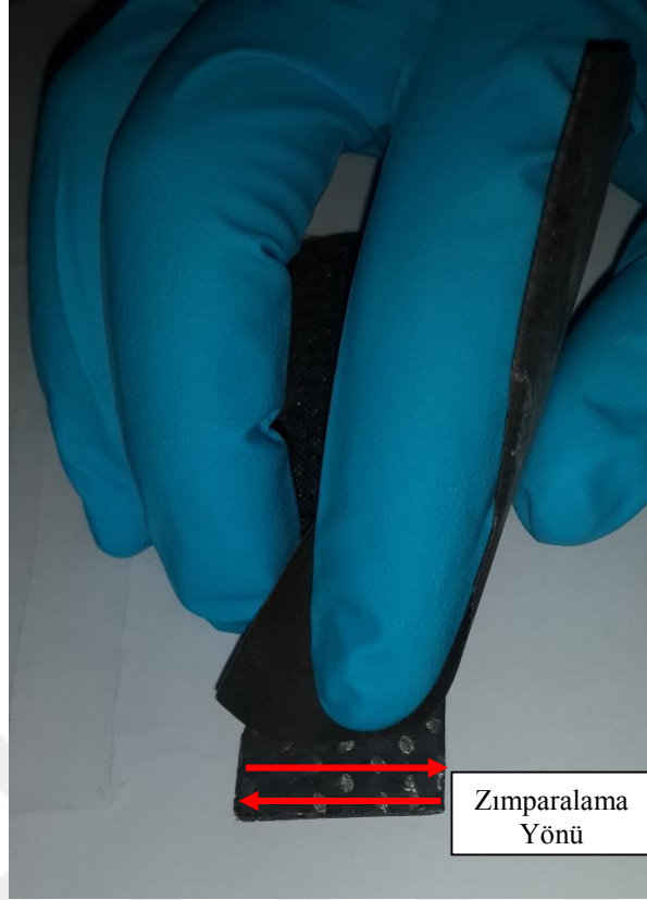
Şekil 3.13. Kompozit levha zımparalama ve temizleme işlemi
