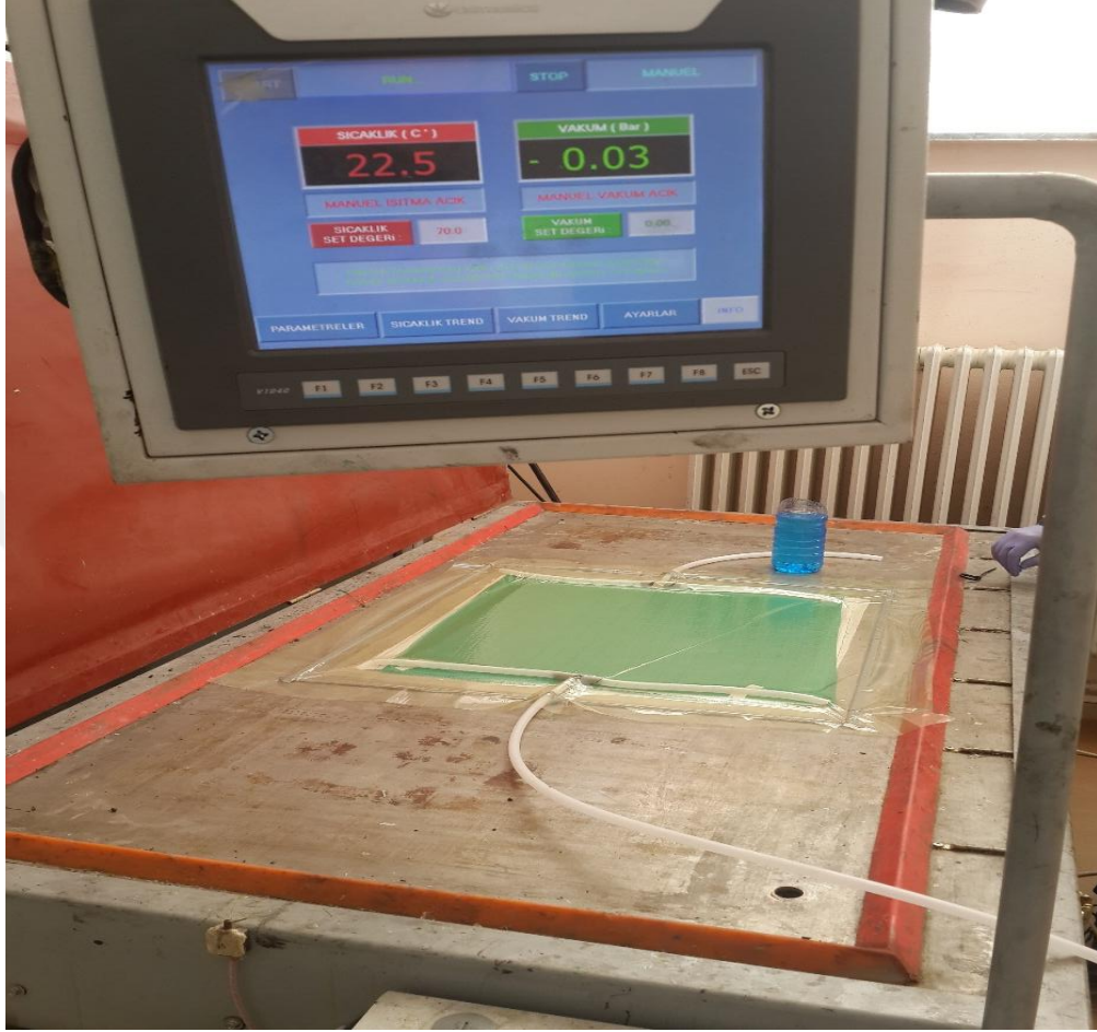
Şekil 3.7. LCD Panel Kontrollü Vakum İnfüzyon Tezgahı
