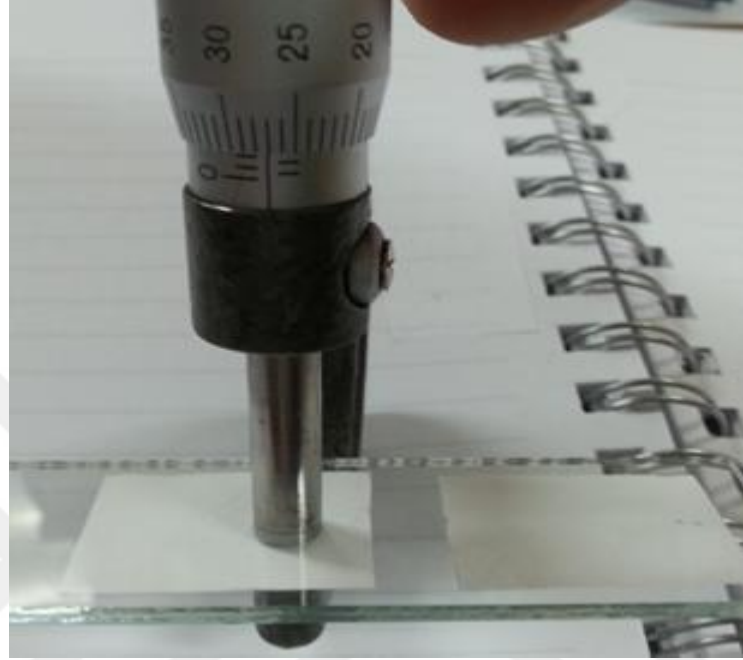
Şekil 3.3. Üretilen nano elyafın kalınlık ölçümü
