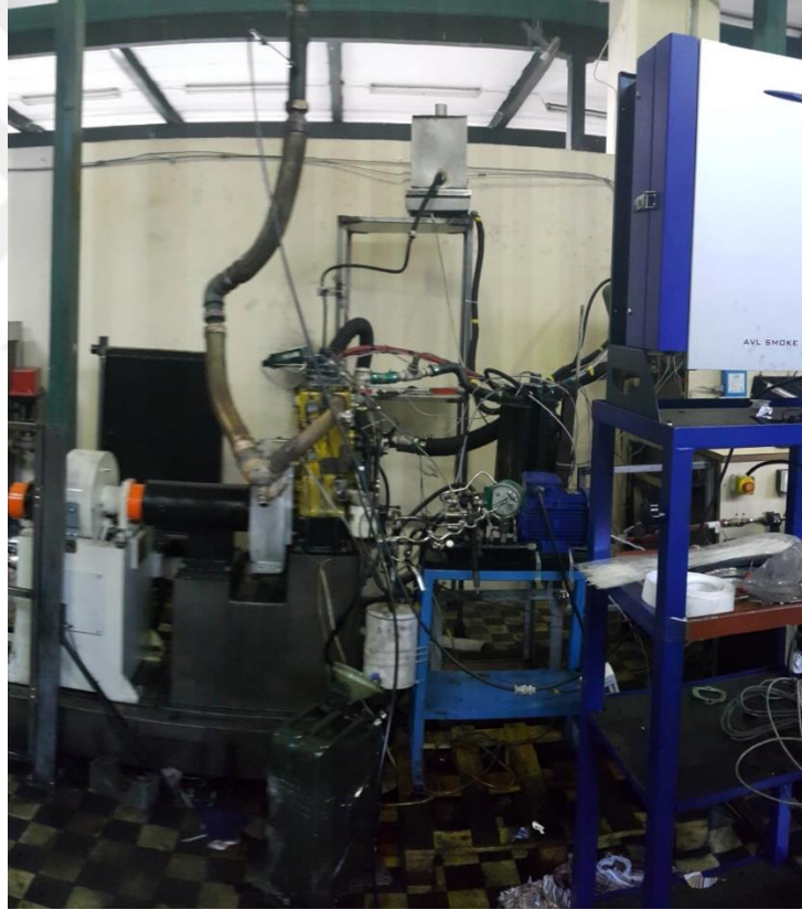
Şekil 3. 18 AVL 415S İs Emisyonu Ölçer
