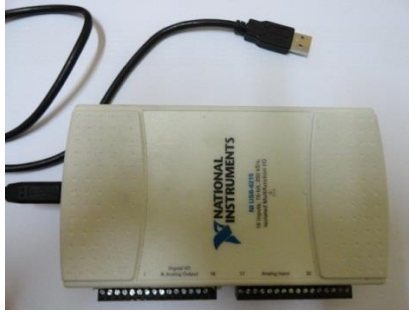
Şekil 3. 21 National Instruments marka USB-6215 tipi veri toplama kartı
