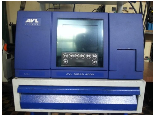
Şekil 3. 17 AVL Digas 4000 Egzoz Emisyonu Ölçer
