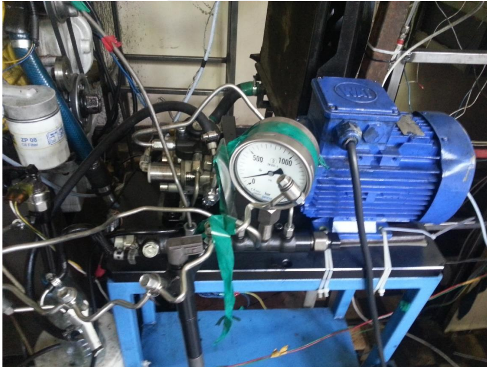
Şekil 3. 5 Dizel yakıt sistemi çizimi ve fotoğrafı
