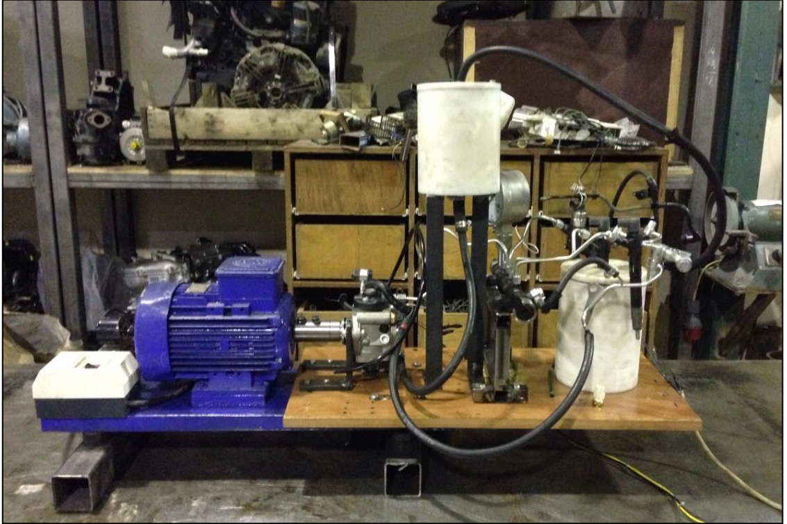
Şekil 3. 7 Dizel yakıt sistemi similatörü şematığı ve fotoğrafı
