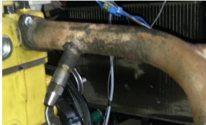
Şekil 3. 20Egzoz hattı termokupl bağlantısı
