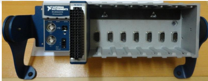
Şekil 3. 22 National Instruments cDAQ modül şasisi
