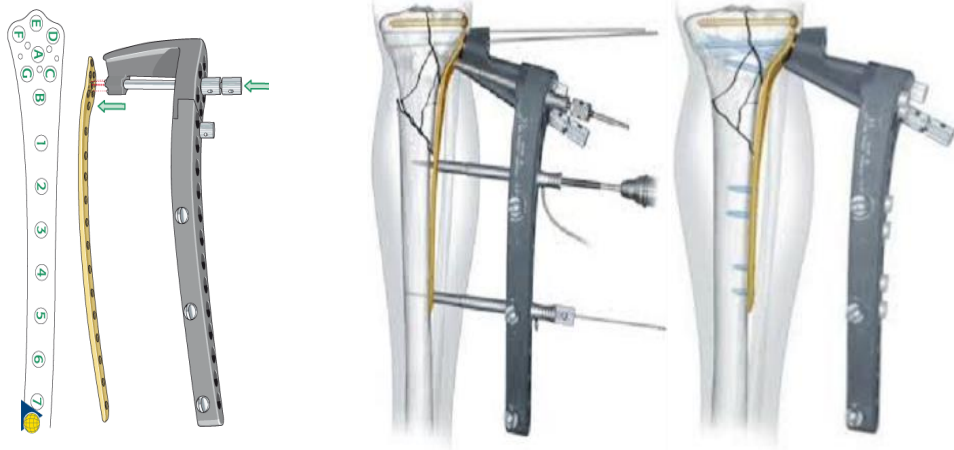
Şekil 29: LISS Plak ve uygulama mekanizması
