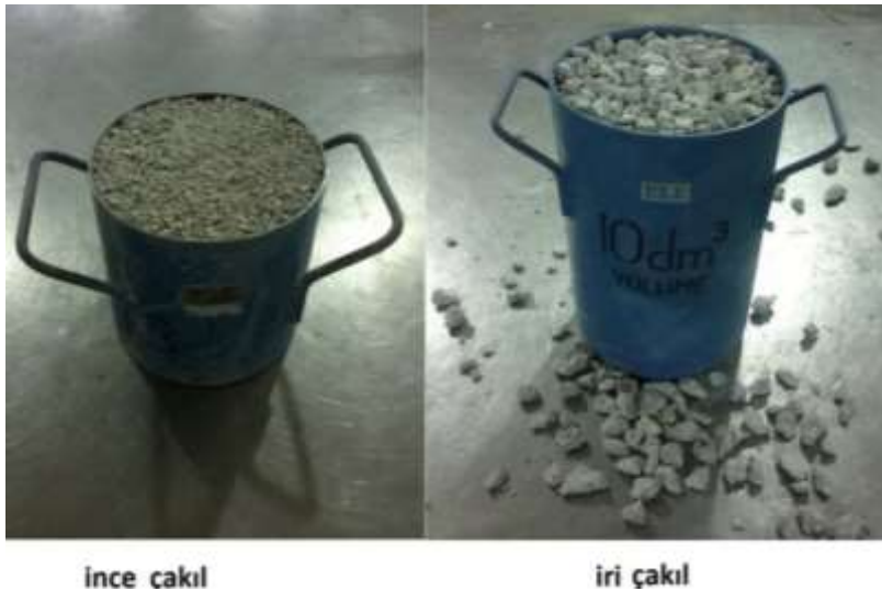
Resim 3.3. Gevşek ve sıkışık birim ağırlık tayini deneyinde kullanılan kalıplar
