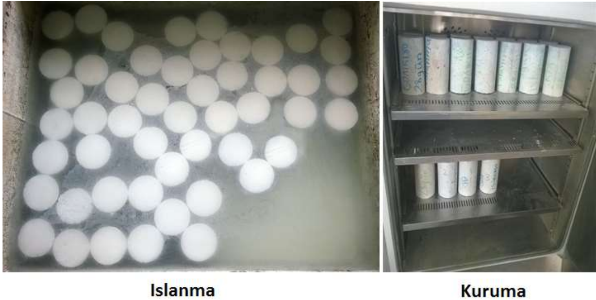
Resim 3.12. Numunelerin kür tankında ıslanması ve 105°C etüvde kurutulması
