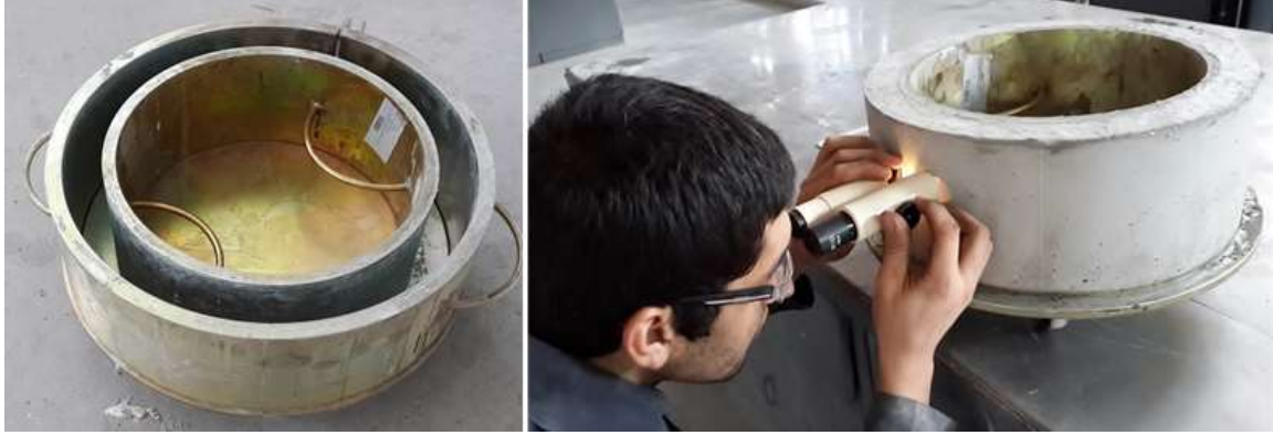
Resim 3.15. Halka kalıbın görüntüsü ve çatlak genişliklerinin ölçülmesi
