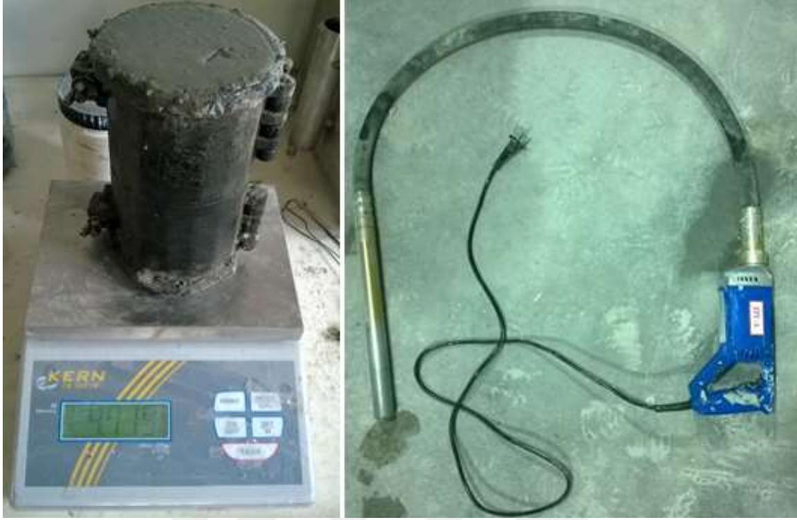
Resim 3.9. Taze beton kütlesinin belirlenmesi ve sıkıştırılmasında kullanılan daldırma vibratörünün görüntüsü
