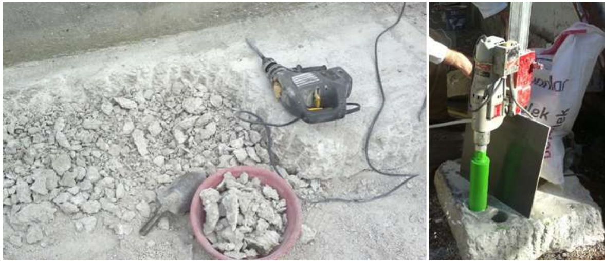
Resim 3.1. Eski betondan geri dönüşüm agregası üretimi ve karot alınması
