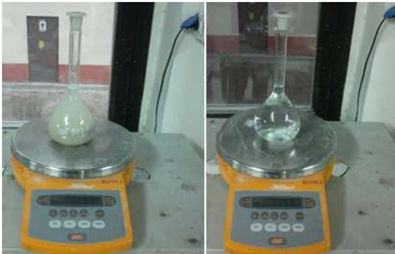
Resim 3.5. Su ve doygun agrega numunelerini içeren balonjojenin görüntüsü
