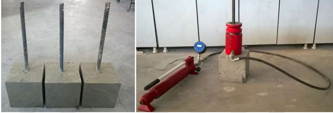
Resim 3.17. Donatı aderans deney numuneleri ve hidrolik pistonlu demir çekme cihazının görüntüsü
