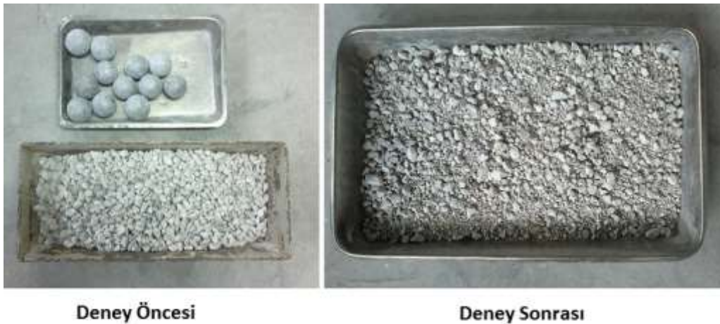
Resim 3.7. Los Angeles deney öncesi ve sonrası numunenin görüntüsü
