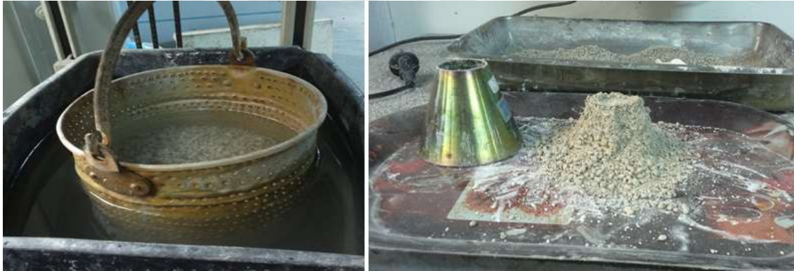
Resim 3.4. Tel sepetin sudaki görünümü ve ince agreganın DYK durumuna getirilmesi
