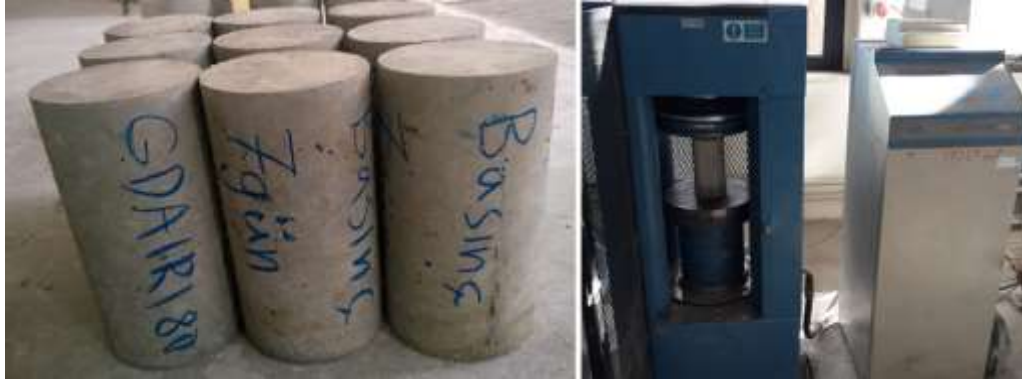
Resim 3.11. 10×20 silindir numuneler ve Beton basınç presi
