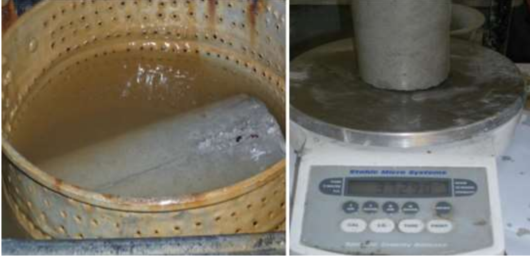
Resim 3.13. Numunenin su içerisinde ve havadaki kütlesinin ölçülmesi
