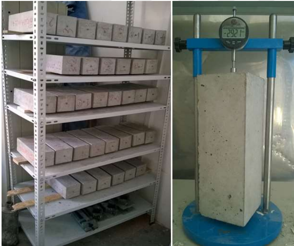
Resim 3.14. Serbest rötre numuneleri ve boy değişiminin ölçülmesi
