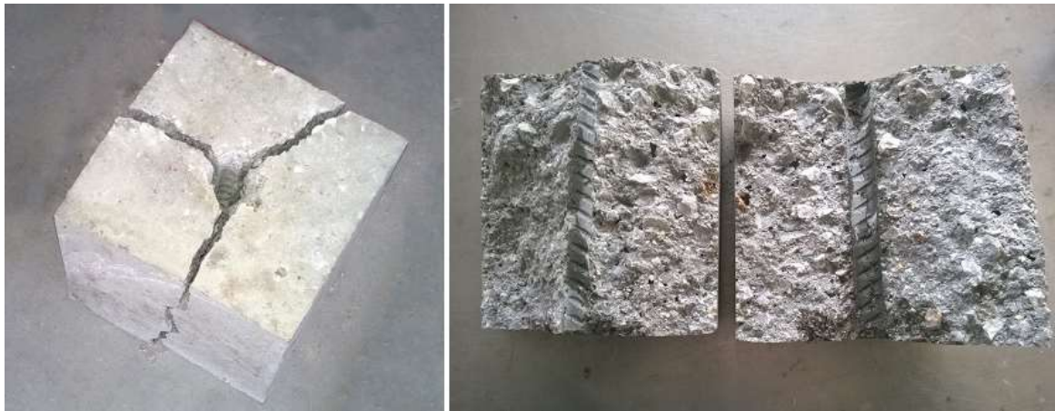
Resim 4.1. Donatı aderans deneyi sonucu parçalanmış beton numunesi ve donatının koptuğu beton yüzeyleri
