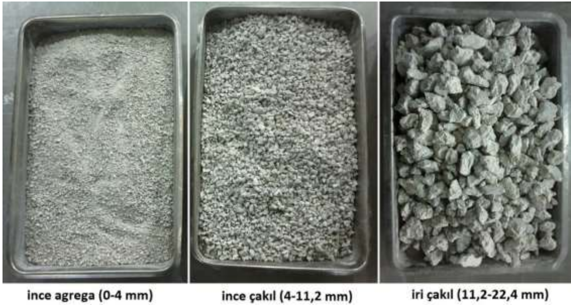
Resim 3.2. Agregaların elenerek gruplara ayrılması
