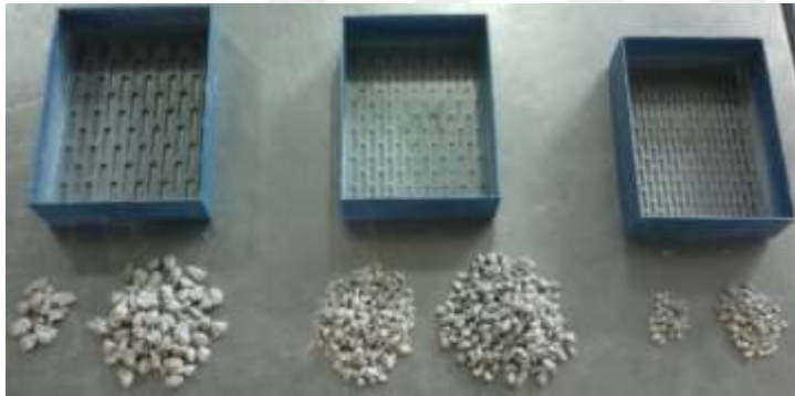
Resim 3.6. Yassılık endeksi deney sonu oluşan agrega grupları
