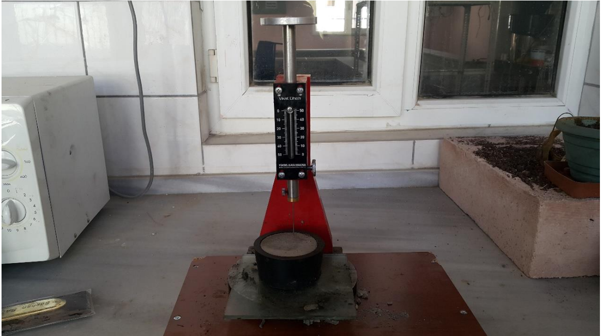
Şekil 3.2. Priz süresi deney düzeneği (Vicat iğnesi)
