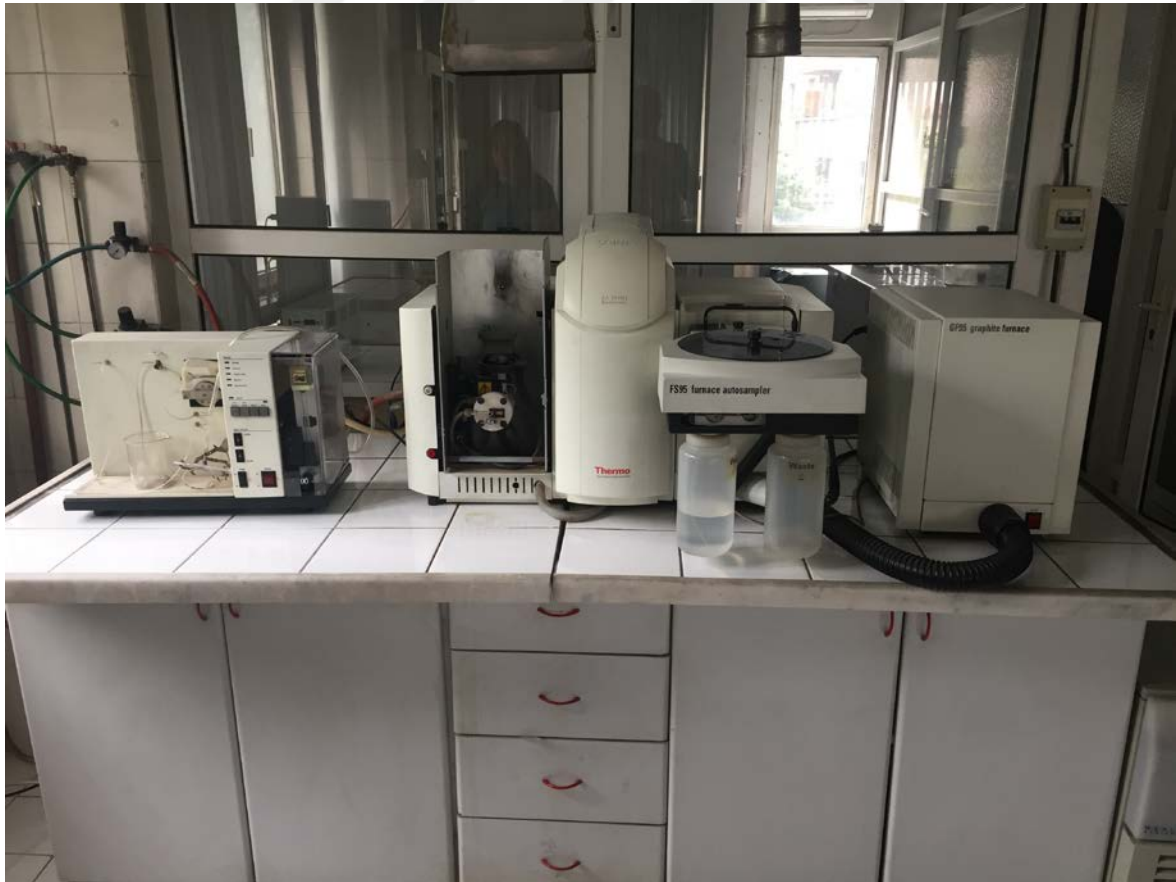
Resim 8.1. Thermo electron comporation marka atomik adsorpsiyon spektrometresi
