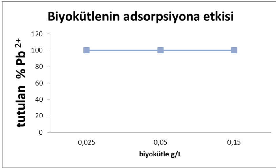
Şekil 10.3. Biyokütle değeri ile bioadsorblanan Pb(II) iyonu değişimi.
