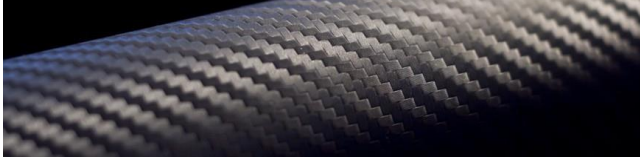
Resim 2.5. Karbon fiber malzemenin yapısı
