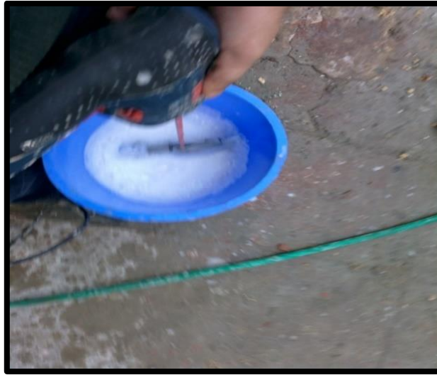
Şekil 3.5. Köpük ajanının su ile karıştırılması
