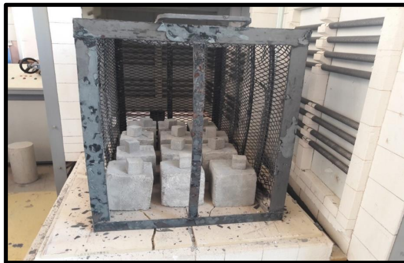
Şekil 3.11. Yüksek sıcaklık fırınında deney sonrası numuneler
