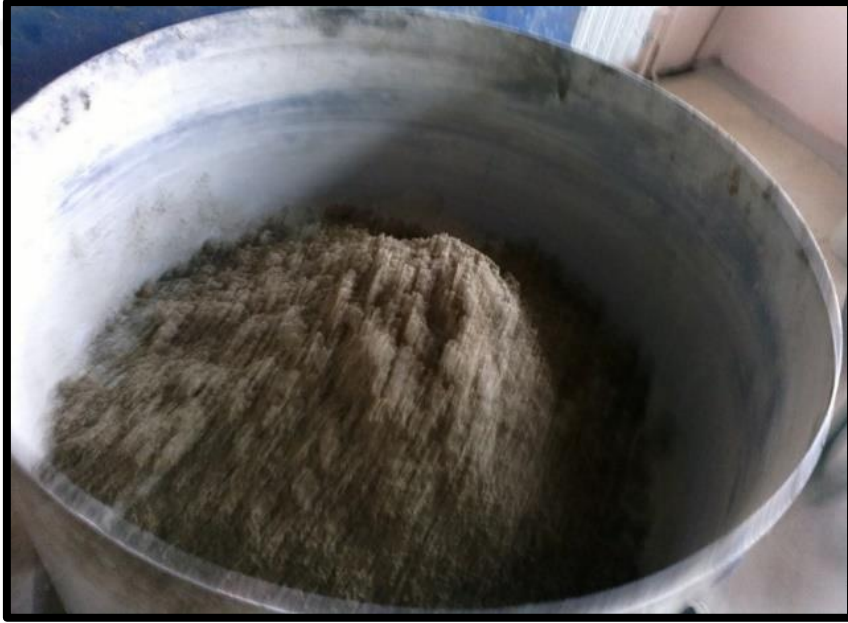
Şekil 3.4. Çimento harcının betoniye de hazırlanması (çimento ve kum karışımı)
