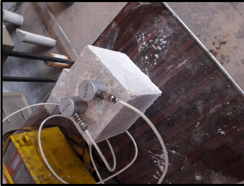
Şekil ek.2. Ultrases geçiş süresi deneyleri
