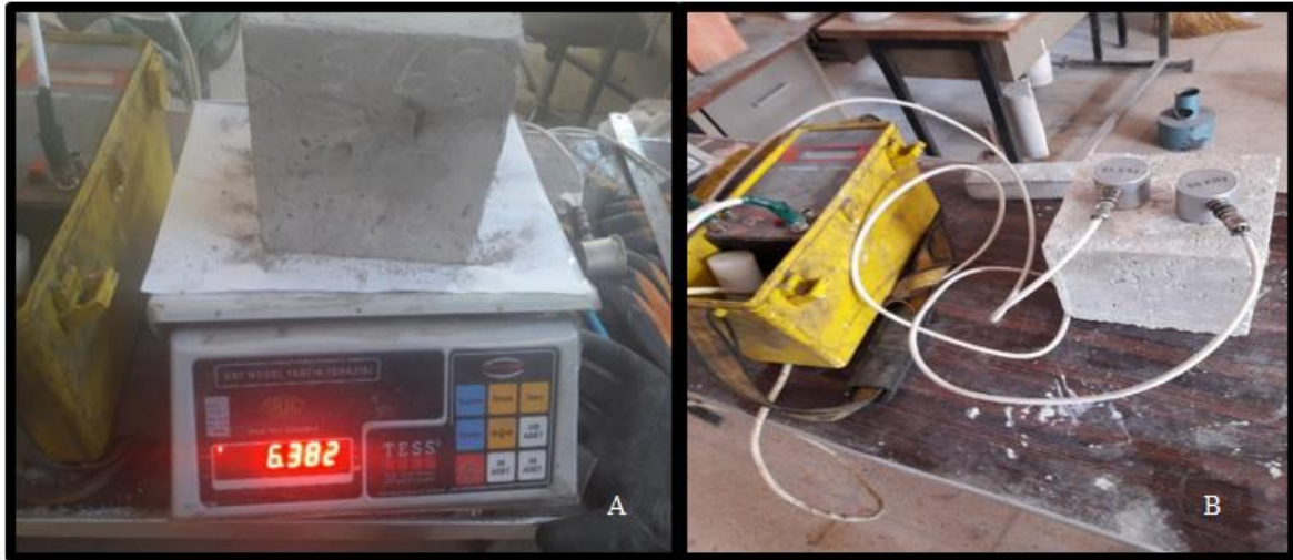
Şekil 3.7. Birim ağırlık ve ultrases geçiş süresi deneyleri
