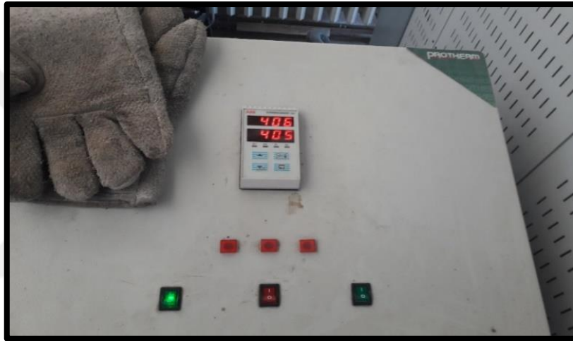
Şekil 3.10. Yüksek sıcaklık fırınında 400 °C'deki gösterge
