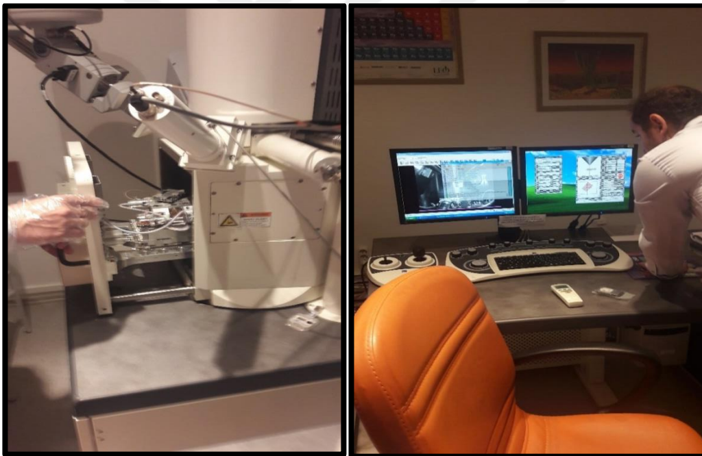
Şekil 3.13. Altın ile kaplanan numunelerin SEM cihazına yerleştirilmesi ve incelenmesi
