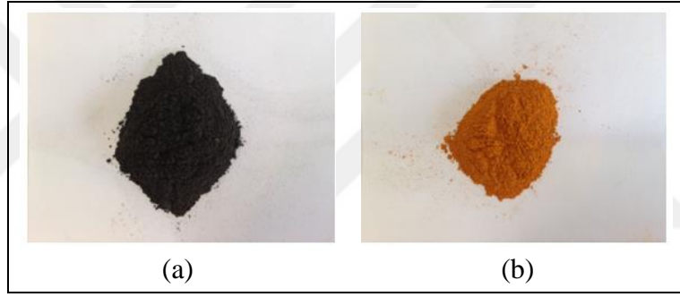
Şekil 5.3: Kalsinasyon öncesinde (a) ve sonrasında (b) elde edilen V 2 O 5 tozları.
