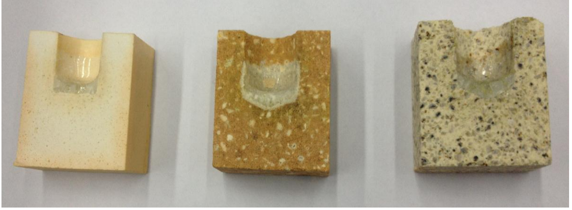
Şekil 6.9 1350°C de 3 saat sonunda numunelerde curuf yayılımı
