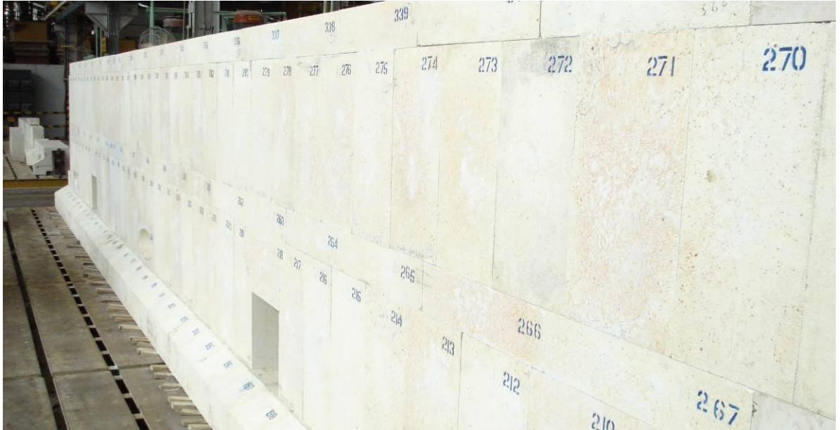
Şekil 3.1 Ergitme döküm refrakter bloklar [26]
