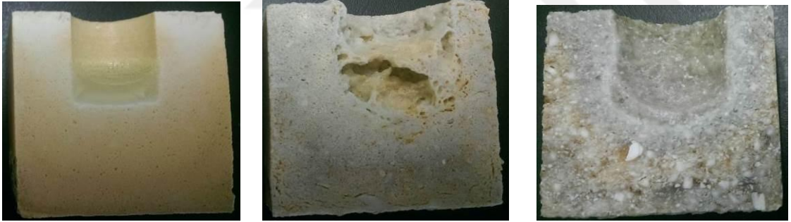
Şekil 6.23 1550°C de 72 saat sonunda numunelerde curuf yayılımı
