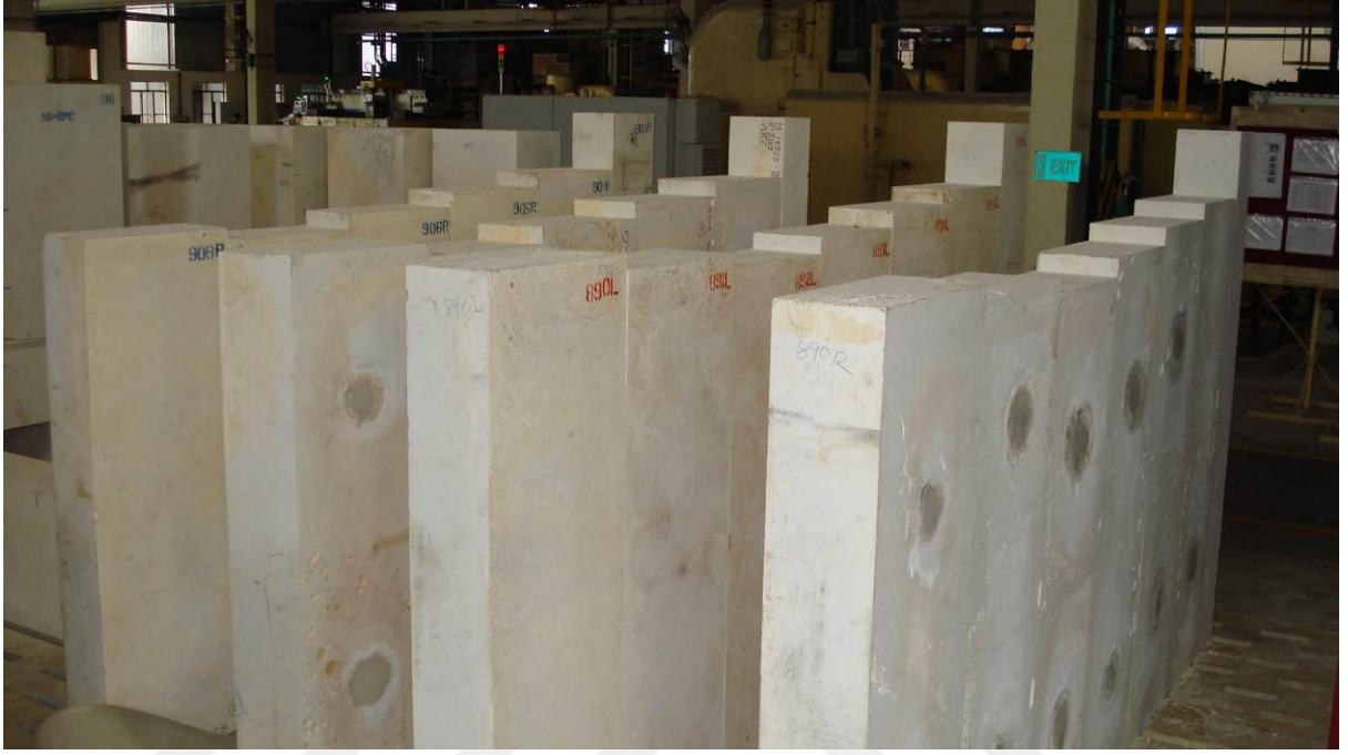
Şekil 3.2 AZS blok refrakterler [26]
