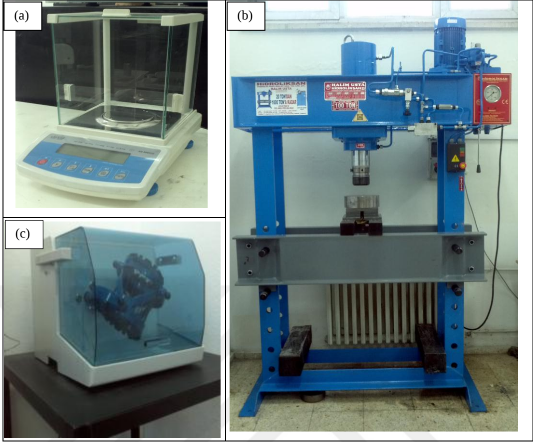
Şekil 5.2. Deneysel çalışmalarda kullanılan; a) hassas terazi, b) hidrolik pres c) turbula cihazı görüntüleri.
