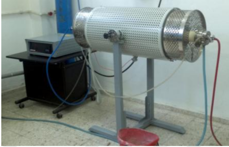
Şekil 5.4. Atmosfer kontrollü sinterleme fırını.
