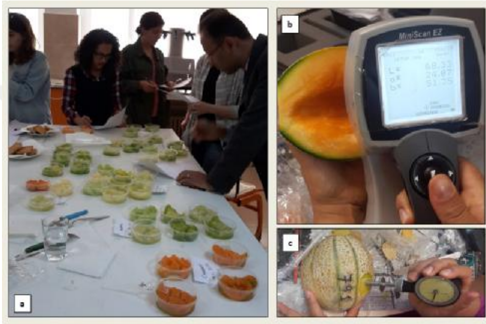
Şekil.3.13. Duyusal analiz (a) ve hunter lab renk ölçer ile renk tayini (b) ve pomolojik analizlerden penetrometre ile meyve sertliğinin ölçülmesi (c).
