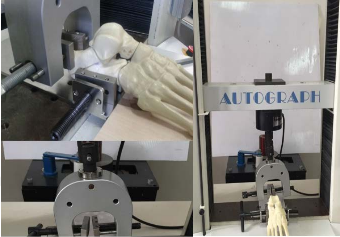
Şekil 3.9: Test düzeneği ( Cihazın ve model sabitleme aparatlarının kurulumu )
