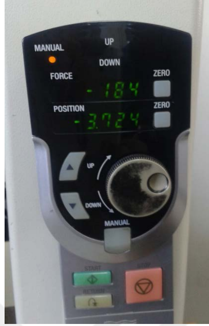
Şekil 3.10: Ön yükleme sonrası sistemdeki kuvvet göstergesi ve milimetrenin ayarlandığı, test sürecindeki verilerin izlenebildiği kumanda
