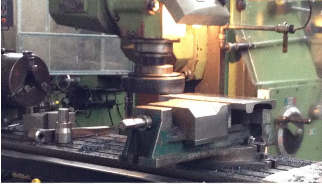
Şekil 3.7. Ray yüzeylerinin frezede işlenmesi
