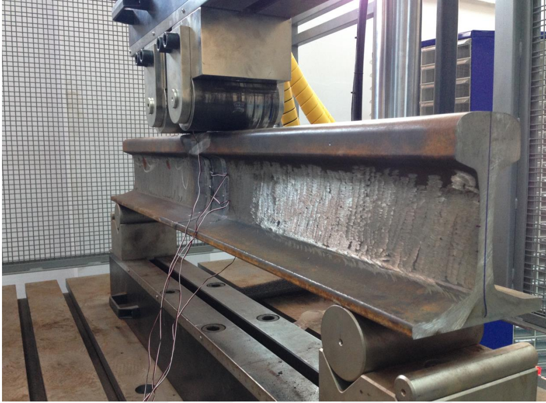
Şekil 5.7. Gerinim ölçerlerin yer aldığı dört nokta eğme test düzeneği
