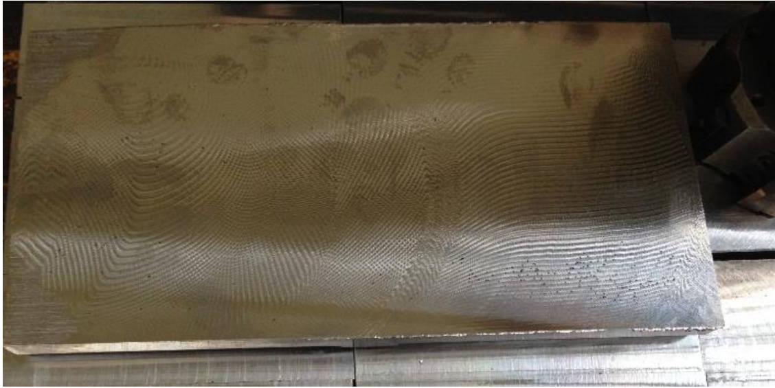
Şekil 3.8. Frezede işleme sonucu oluşan ray kesiti yüzeyi
