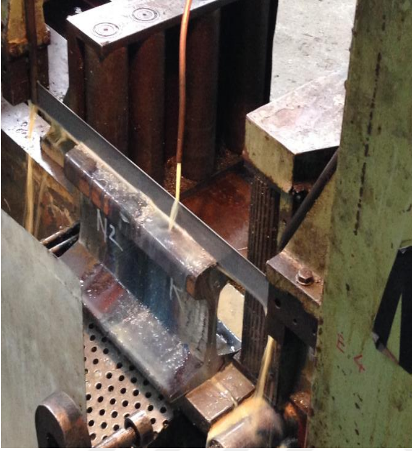
Şekil 3.6. Sertlik testi için testere ile kesit alma
