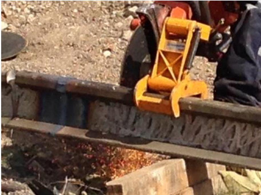
Şekil 3.4. Deneysel çalışmalarda kullanılan ray numunelerinin sahada kesilmesi işlemi
