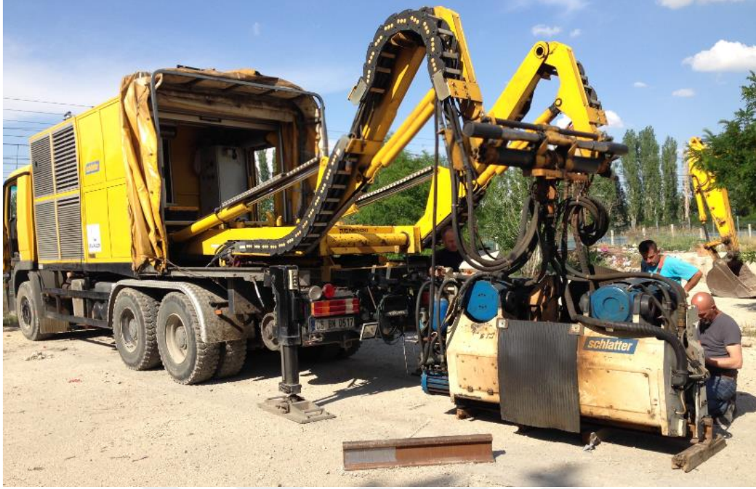
Şekil 2.1. Deneysel numunelerin hazırlanmasında kullanılan Schlatter marka alın kaynağı makinesi genel görünümü
