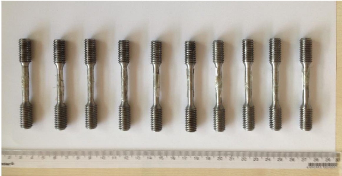
Şekil 3.20. Hazırlanan çekme çubuğu numuneleri
