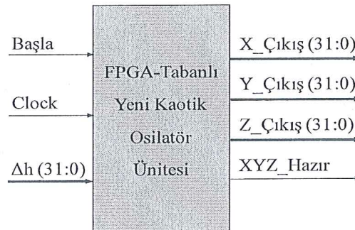
Şekil 4.17. FPGA-tabanlı yeni kaotik osilatör ünitesi en üst seviye blok diyagramı [63].
