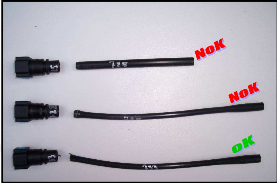
Şekil 4.2. Numune parça kopma örnekleri
