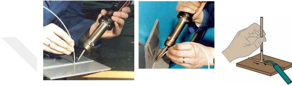
Şekil 1.1. Sıcak gaz kaynağı (1)
