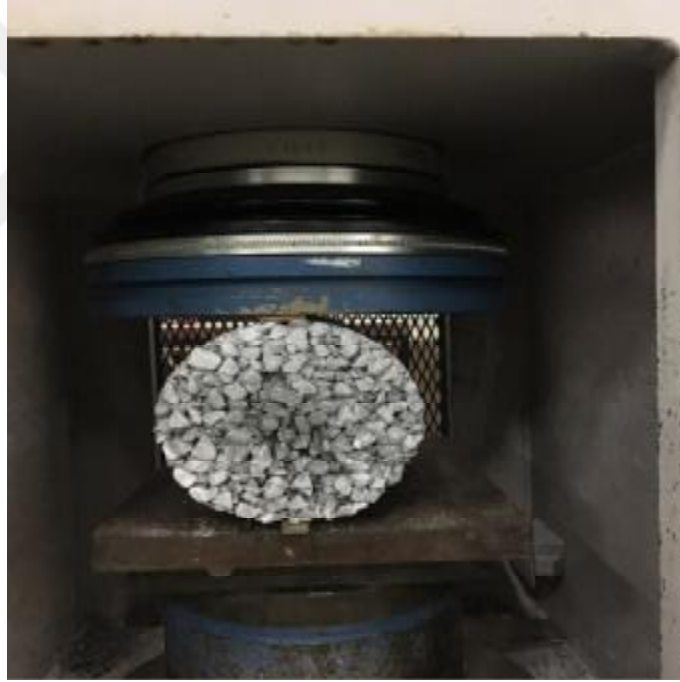
Şekil 3.14. Silindir yarma dayanımı deneyi
