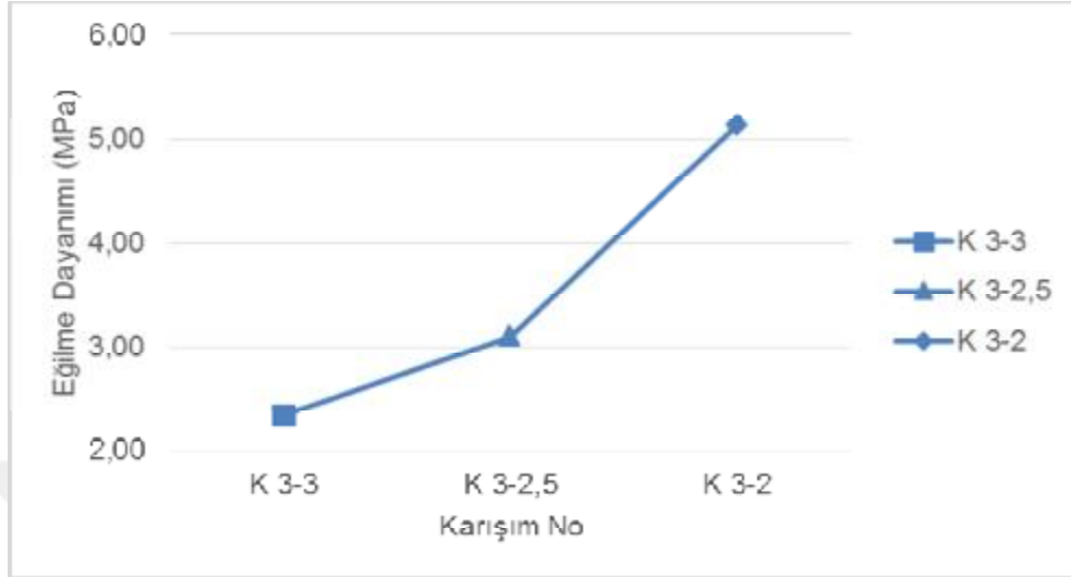
Şekil 4.61. 8-16 mm agregalı karışımlara ait ortalama eğilme dayanımı değerleri
