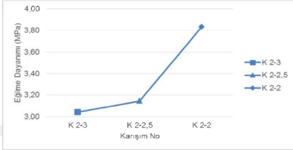
Şekil 4.60. 4-8 mm agregalı karışımlara ait ortalama eğilme dayanımı değerleri
