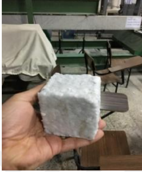
Şekil 3.20. Parafınle kaplı geçirimli beton numune
