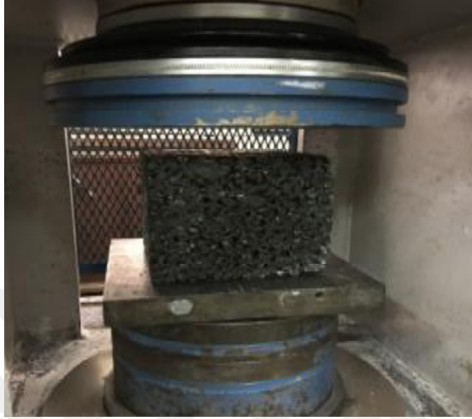
Şekil 3.11. 150x150x150 mm boyutlu küp numune basınç dayanımı deneyi
