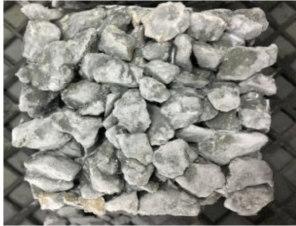
Şekil 3.16. İri agregalar kullanılarak elde edilen örnek geçirimli beton yüzeyi
