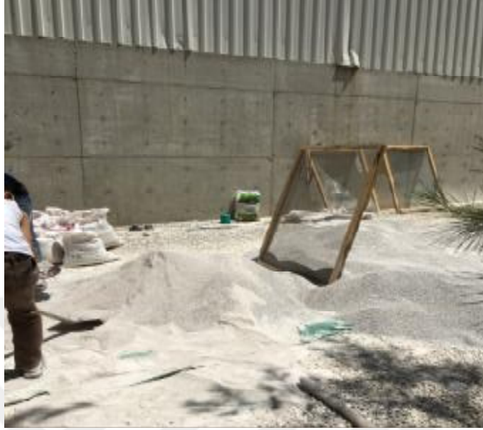
Şekil 3.2. Saha koşullarında agrega eleme işlemi
