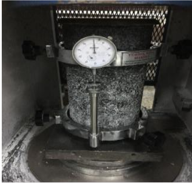
Şekil 4.25. Geçirimli beton silindir numune basınç deneyi
