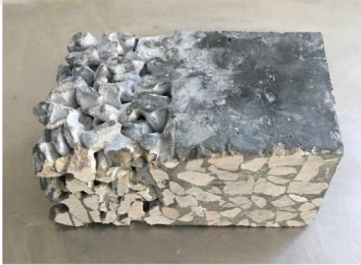
Şekil 4.57. K 3-2'ye ait eğilme kirişi numunesinden beton kesme makinesi yardımıyla alınan bir parçanın kesit görünümü
