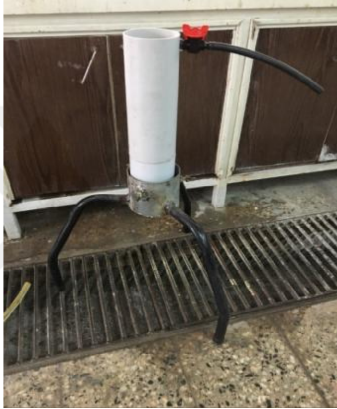
Şekil 3.25. Düşen seviyeli permeabilite deney düzeneği (2.Yöntem)
