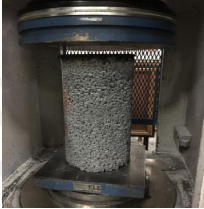
Şekil 3.10. 150x300 mm boyutlu silindir numune basınç dayanımı deneyi
