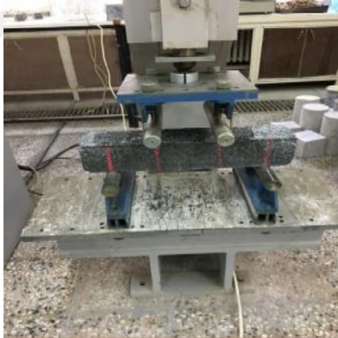
Şekil 3.13. Geçirimli beton eğilme dayanımı deneyi
