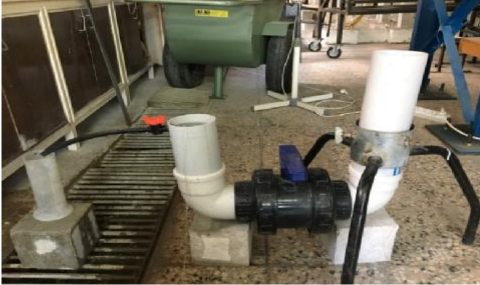
Şekil 3.24. Permeabilite deney düzeneği
