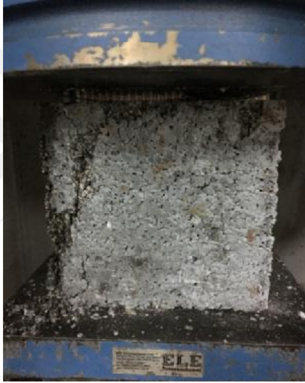
Şekil 4.56. K 1-2 karışımına ait küp numunenin deney sonundaki görüntüsü
