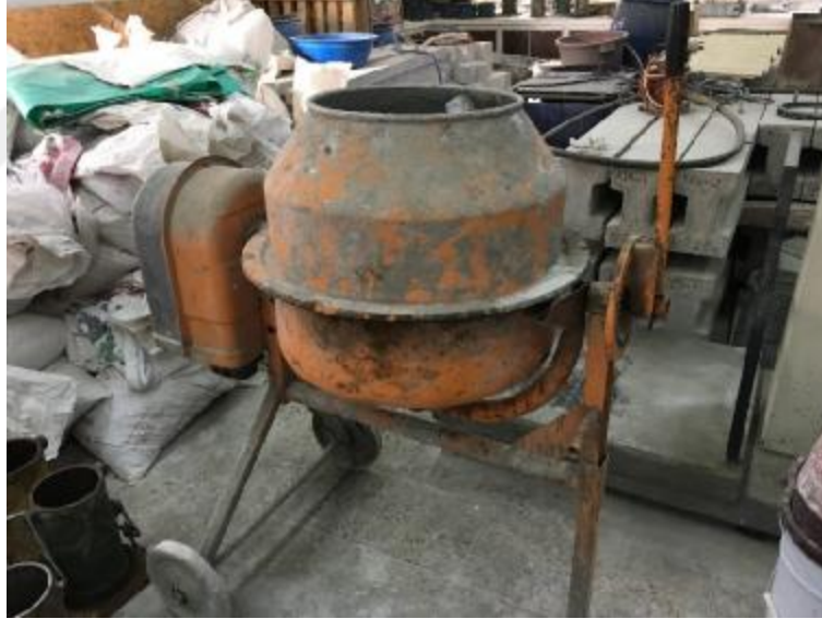
Şekil 3.8. Deneylerde kullanılan devirmeli betoniye
