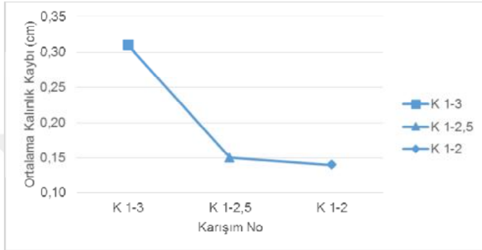
Şekil 4.75. 2-4 mm agregalı karışımlara ait ortalama kalınlık kaybı değerleri
