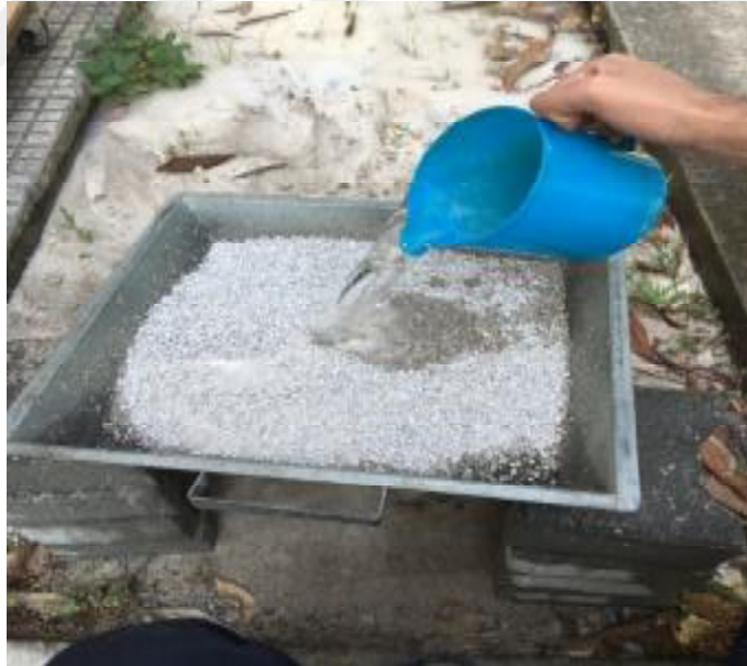
Şekil 3.3. Agrega yıkama işlemi
