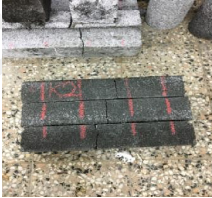
Şekil 4.58. Kiriş numunelerin test sonrası görünümü
