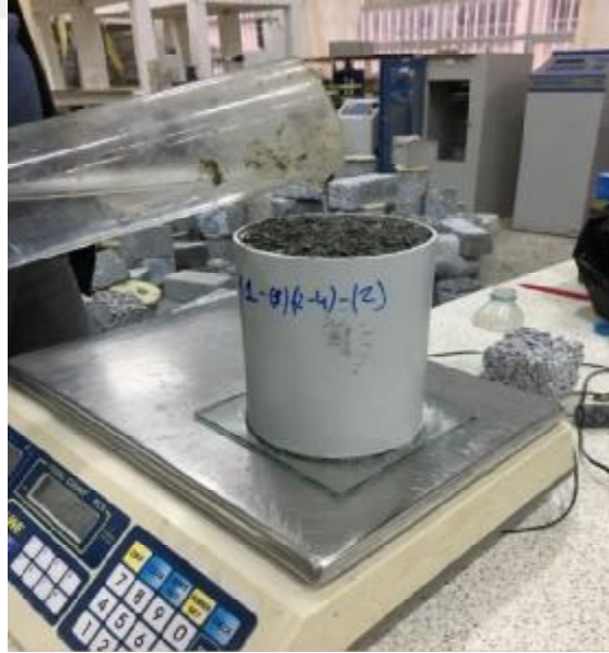
Şekil 3.21. Hacimsel porozite deneyi
