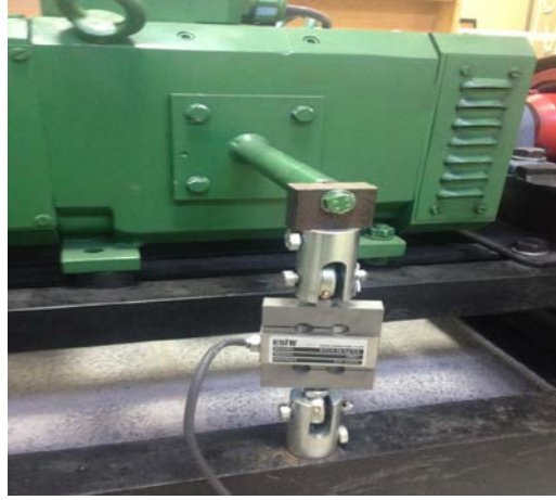
Şekil 3.5. Yük hücresinin görünümü.
