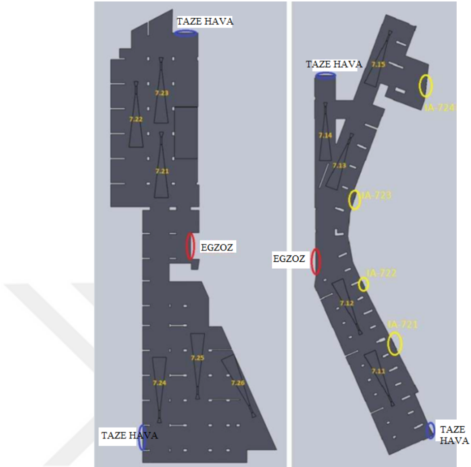
Şekil 1.2. Jet fan, taze hava ve egzoz menfezleri yerleşimlerinin gösterimi [5].
