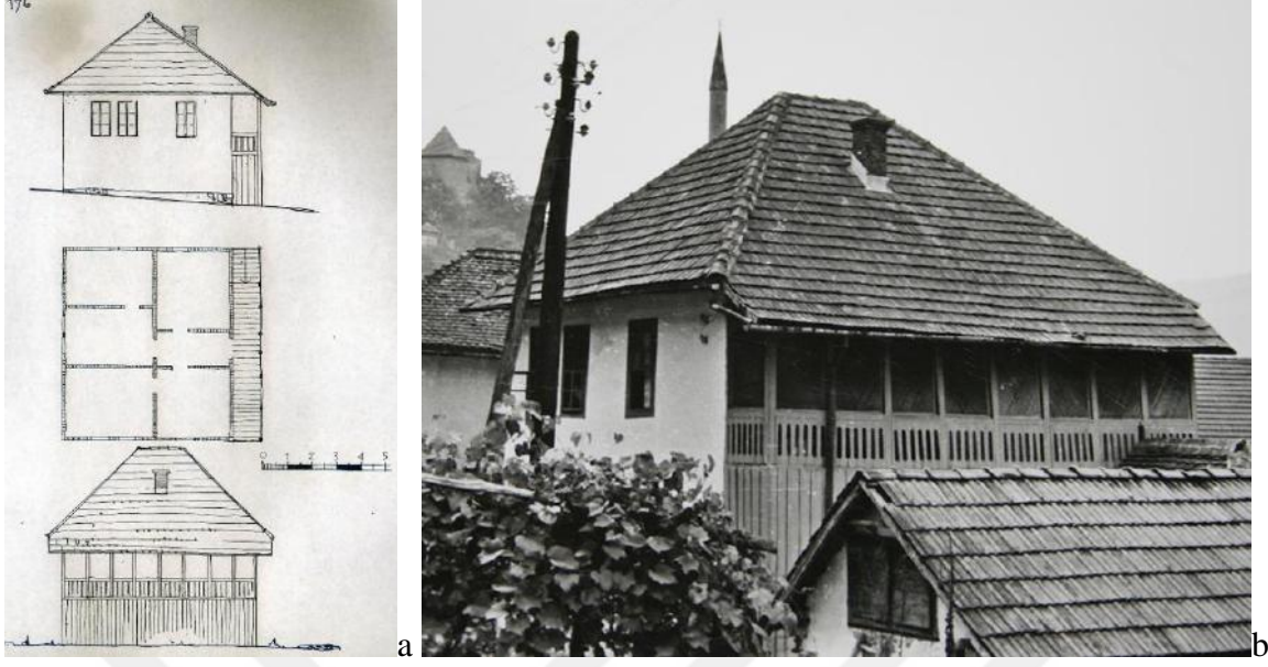
Resim 3.59. (a) Tek katlı bir ev örneğinin plan ve cepheleri ile (b) görünümü (Maglay Belediyesi)
