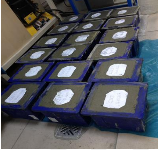
Şekil 3.2: Numune şekli, boyutları ve kalıp içindeki betonlar.
