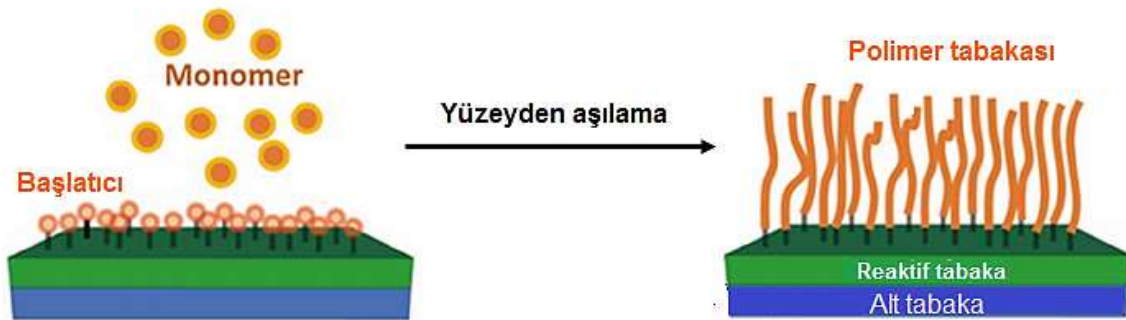
Şekil 2.9. Yüzeyden başlatılan polimerleşmenin şematik olarak gösterimi [41].
