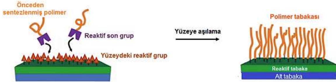
Şekil 2.8. Yüzeye aşılama yönteminin şeması.
