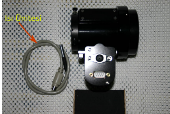
Şekil 4.9 : Optic TCF-S ısı duyarlı Focuser.
