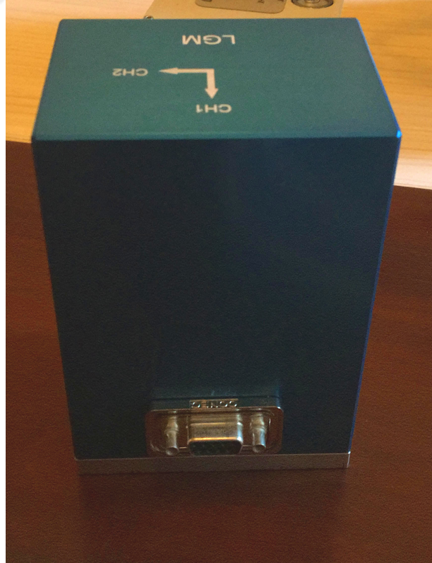
Şekil 4.7 : Yüksek çözünürlüklü eğimölçer (HRTM).
