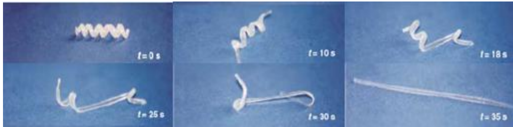
Şekil 2.2. Sıcaklık duyarlı bir ŞHP’nin kalıcı şekline toparlanması [6]
