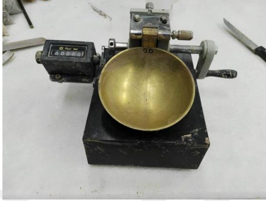
Şekil 4.8. Casagrande Deney Aleti(ESOGÜ)
