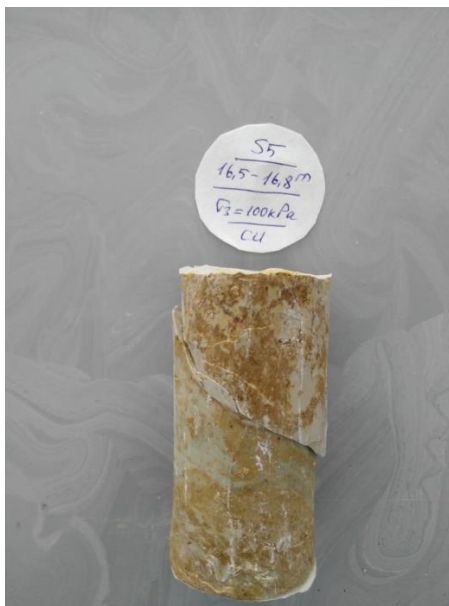
Şekil 4.19. Konsolidasyonlu – Drenajsız(CU) Üç Eksenli Deney Numunesi (Deney Sonu)
