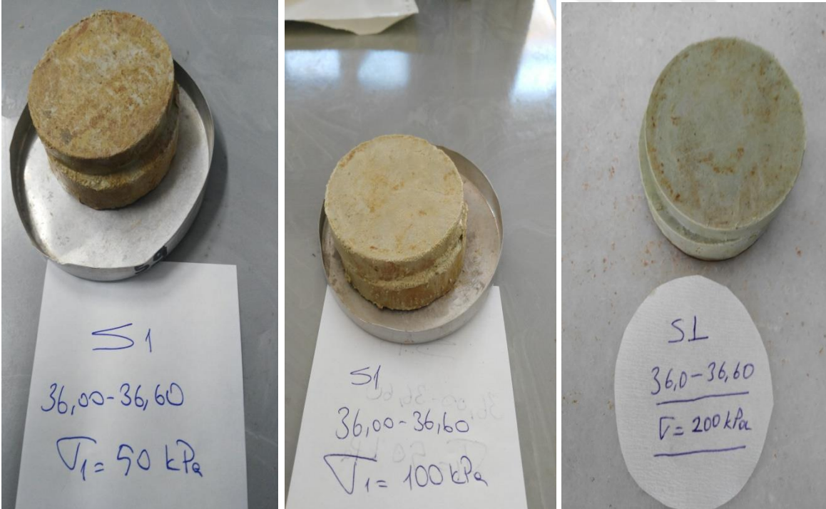
Şekil 4.18. Kesme Kutusu Deney Numuneleri (Deney Sonu)
