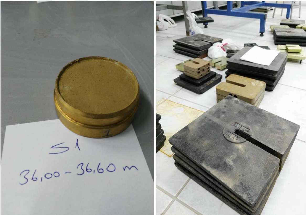
Şekil 4.14. Konsolidasyon Deney Numunesi(Deney Sonu) ve yükleme ağırlıkları
