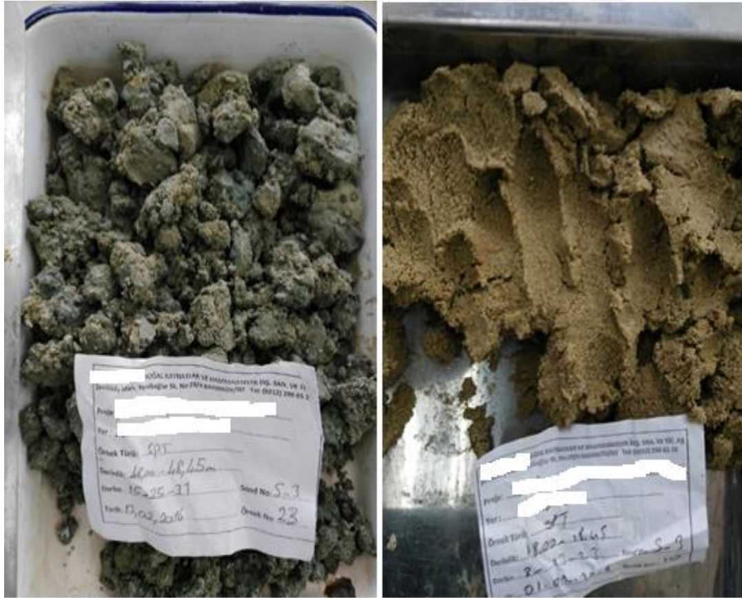
Şekil 4.5. Tanımlama Deneyleri için alınmış numuneler
