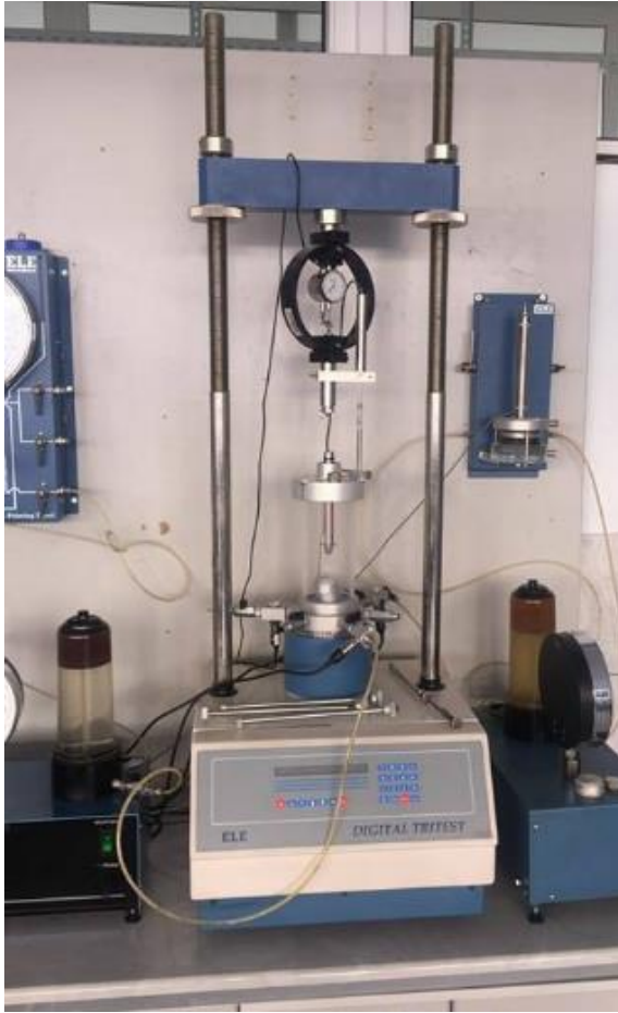
Şekil 3.14. Üç eksenli deney aleti(ESOGÜ)
