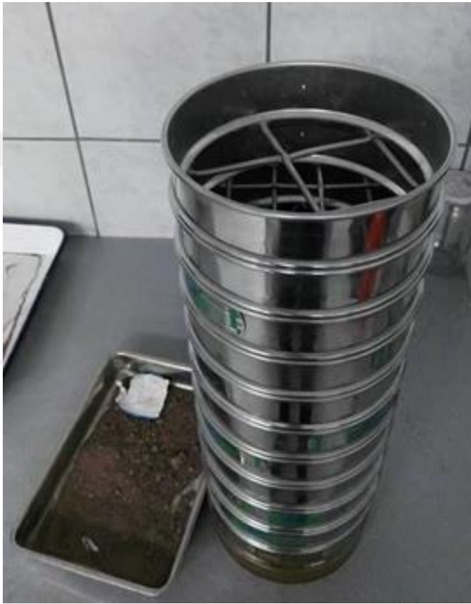
Şekil 4.6. Elek Seti ve elenmek üzere hazırlanmış numune(ESOGÜ)
