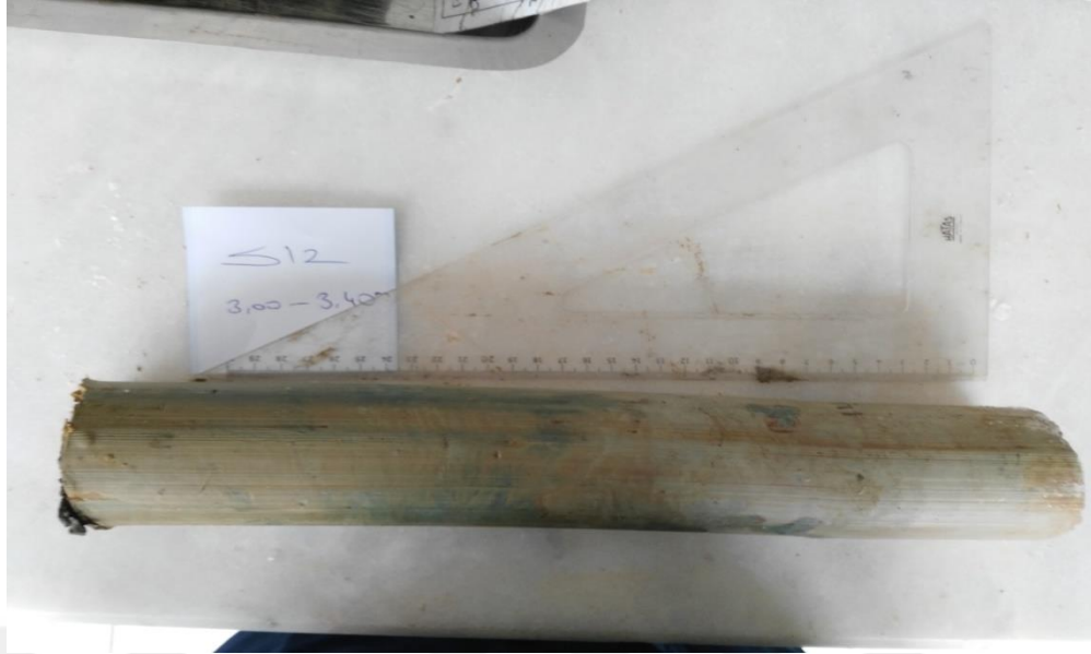
Şekil 4.4. Mekanik krikoyla çıkarılan numune
