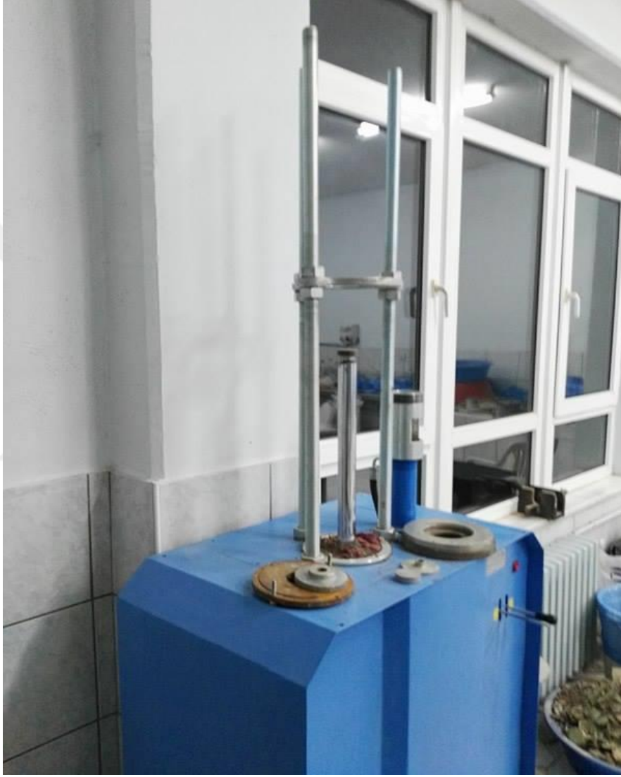
Şekil 4.2. Tüplerden numuneyi çıkarmak için kullanılan kriko(ESOGÜ)
