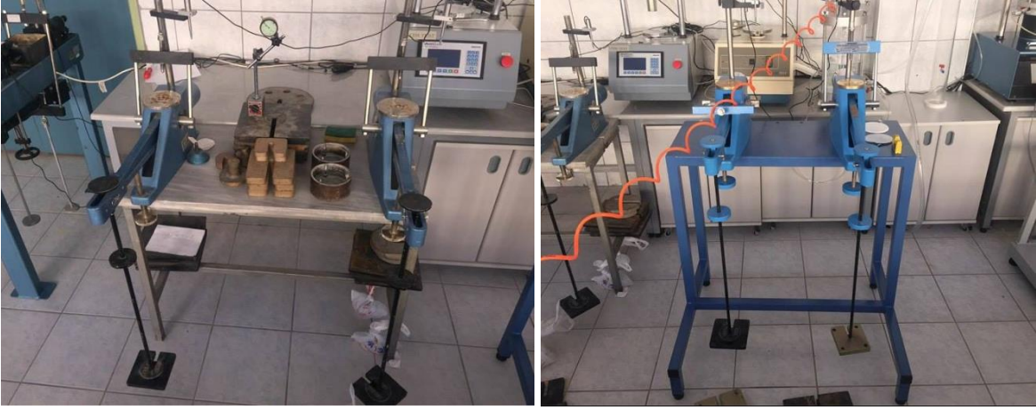
Şekil 4.11. Konsolidasyon deney aletleri(ESOGÜ)
