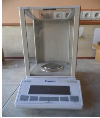
Şekil 3.18 : Arřimet yoğunluk ölm dzeneęi olarak kullanılan Precisa™ hassas terazi.
