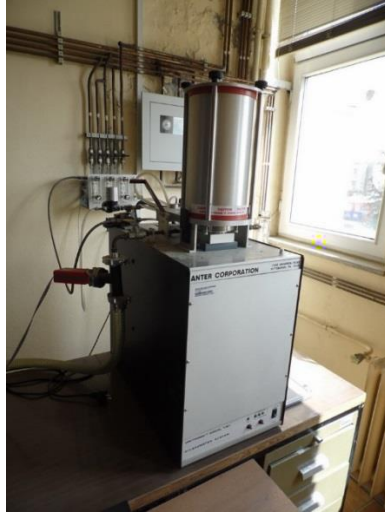
Şekil 3.12 : 1700 Anter™ Gazaltı Dikey Dilatometresi.
