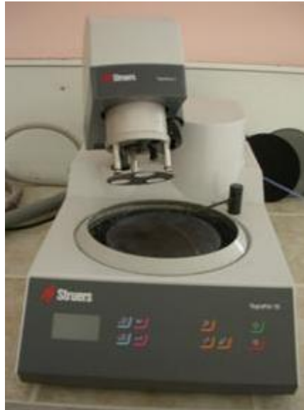
Şekil 3.15 : Struers™ Tegrapol-15 parlatma cihazı.
