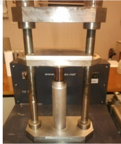
Şekil 3.11 : —MSTEC™ BM-0805 hidrolik pres MSE tek eksenli hidrolik el presi (10 ton).
