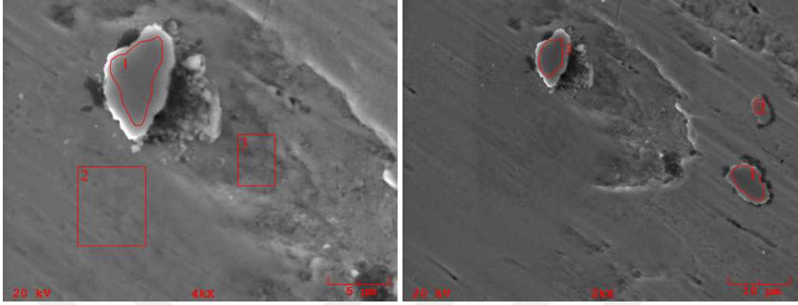
(a) D2 Aşınma SEM 4000x bölge A
