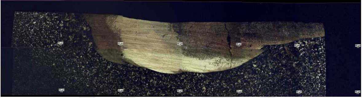
Şekil 4.36: E1 numunesi 50x panoramik görüntüsü, %2 Nital 40s
