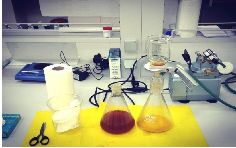
Fotoğraf 3.9. Büchner Hunisi kullanılarak oluşturulan Filtrasyon Düzeneği
