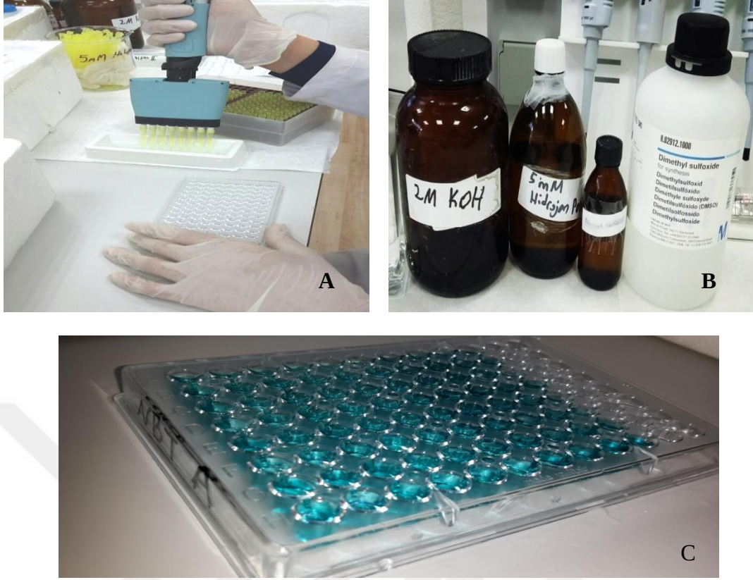
Fotoğraf 3.30. Nitroblue tetrezolium (NBT) azaltılma analizi. A. NBT solüsyonları düz tabanlı 96-hazne plağa eklenir. B. NBT solüsyonu azaltma analizi. C. NBT tahlilinde 96-hazne plaka kullanıldı, Solunum patlaması aktivitesi deneyinin son bölümü.
