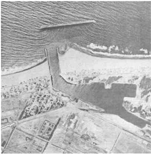
Şekil 3.8. Kaliforniya Channel Adaları limanı dalgakıranı (SPM 1984)
