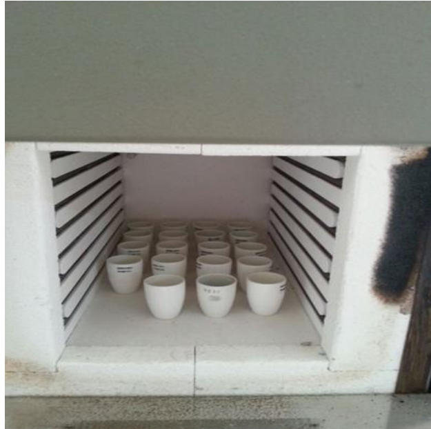
Şekil 3.11: Sediment örneklerinin kül fırınına yerleştirilmesi.
