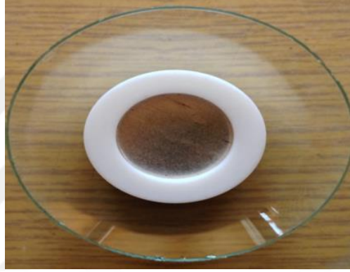
Şekil 3.25: Kapak ve manyetik bardan oluşan taşıyıcı sistem.
