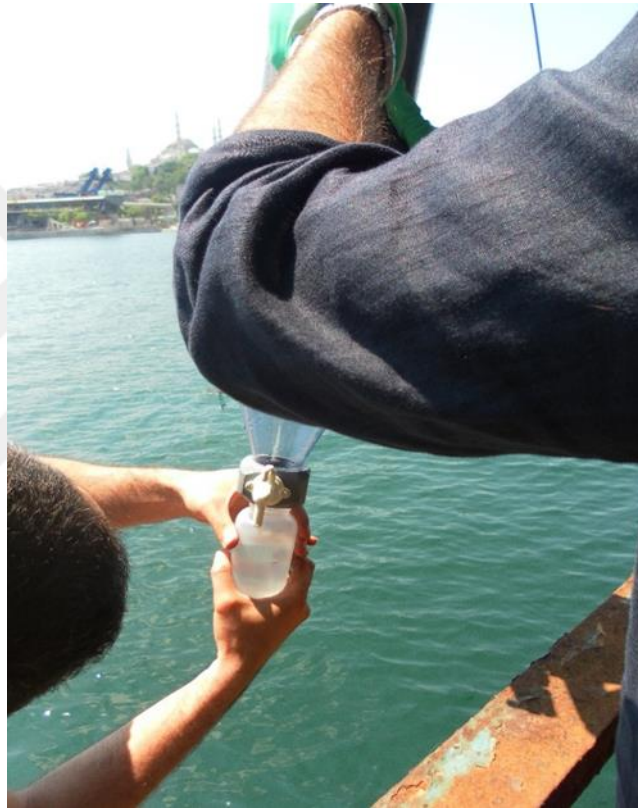
Şekil 3.4: Toplama kabının tuzğa yerleştirilmesi.
