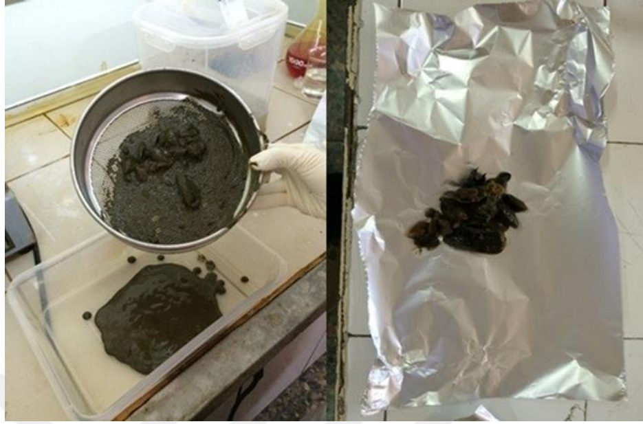
Şekil 3.13: Sediment örneklerinde yağ eleme yöntemi.
