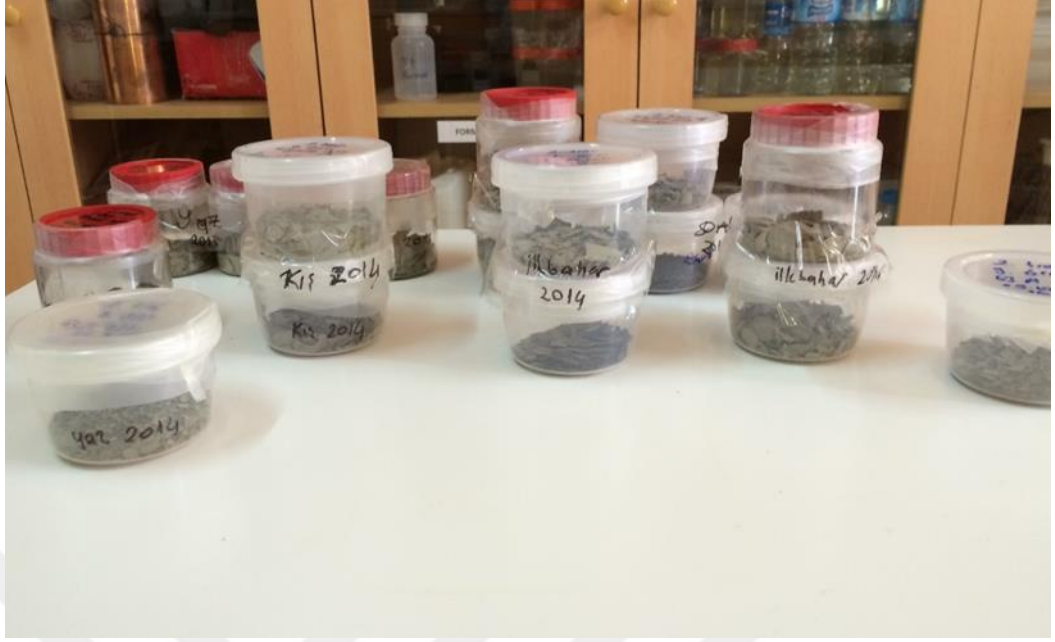
Şekil 3.16: 170 ml ölçüm kaplarında bulunan sediment örnekleri.
