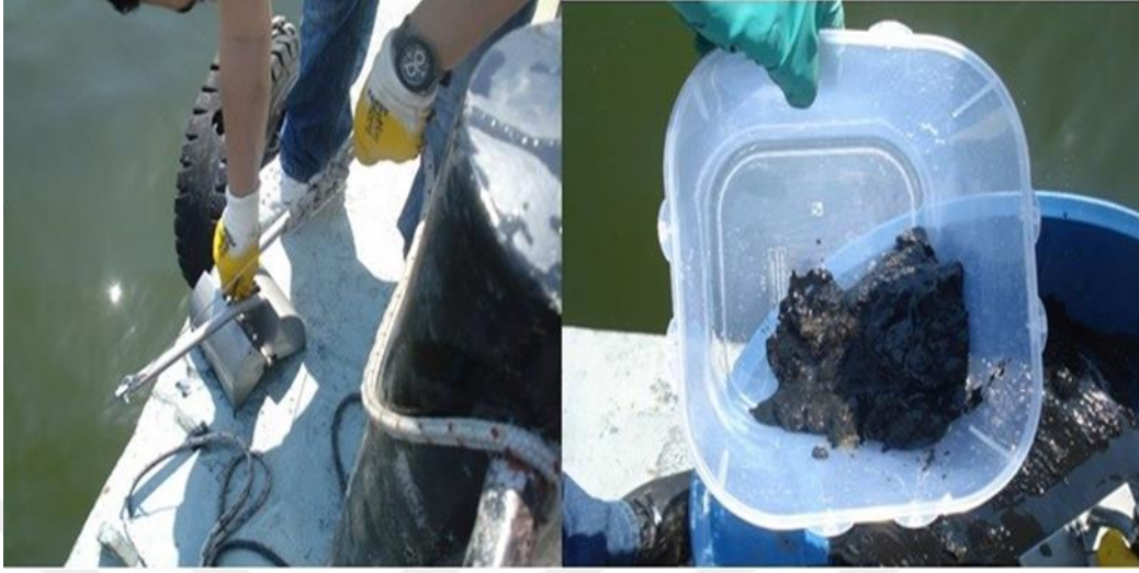
Şekil 3.6: Dip sediment örneklemesinin yapılması.
