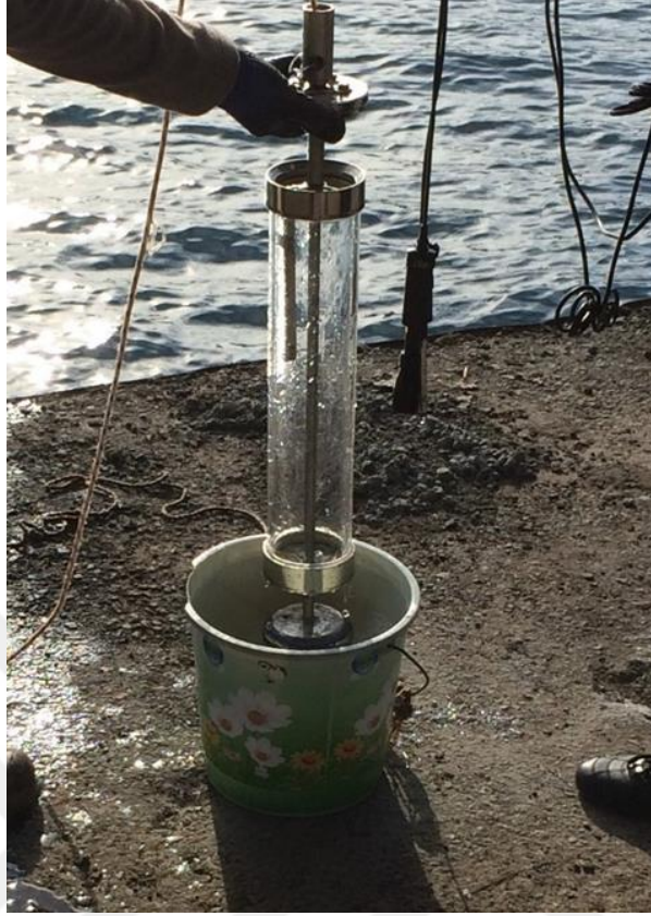
Şekil 3.7: Nansen şişesi ile yapılan su örnekleme.
