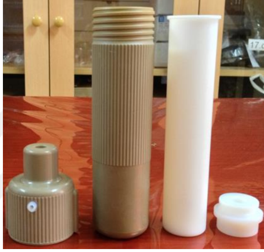
Şekil 3.21: Örneklerin sildirildiği teflon kaplar.
