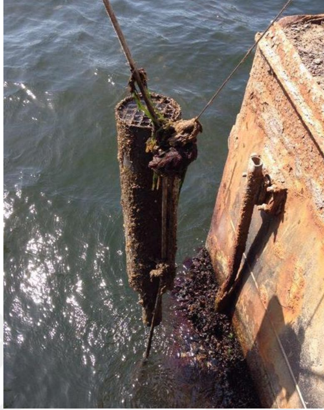
Şekil 3.5: Sediment tuzağının su yüzeyine çıkarılması.
