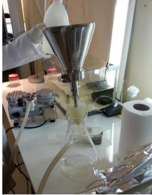
Şekil 3.10: Filtrasyon sisteminde süzme işlemi.
