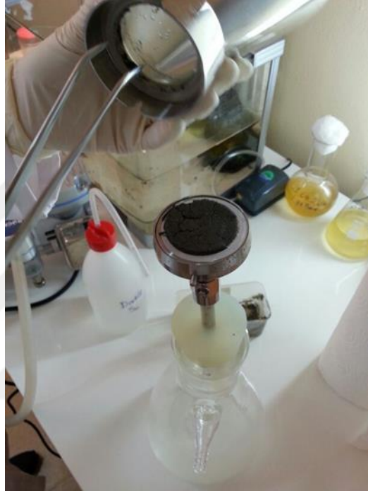
Őekil 3.14: Sediment rneđinin filtrasyonu.
