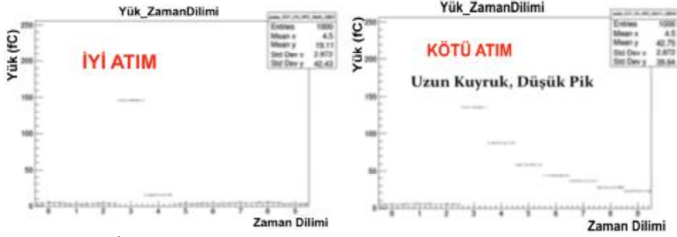
Şekil 4.18. İyi ve kötü çipin ICI grafikleri (x eksenı zaman dilimi, y eksenı yük miktarını göstermektedir)
