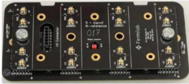
Şekil 3.17. HF R7600 FÇT için kullanılan adaptör kartı (CMS Collaboration, 2012, CMS-TDR-010)
