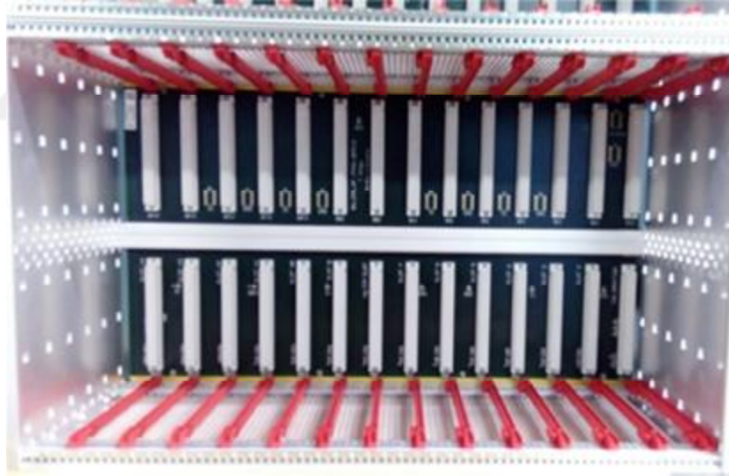
Şekil 4.3. Montajı tamamlanan boş bir kasa
