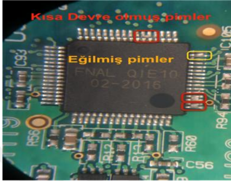
Şekil 4.7.(c) Kısa devre olmuş ve eğilmiş pimler
