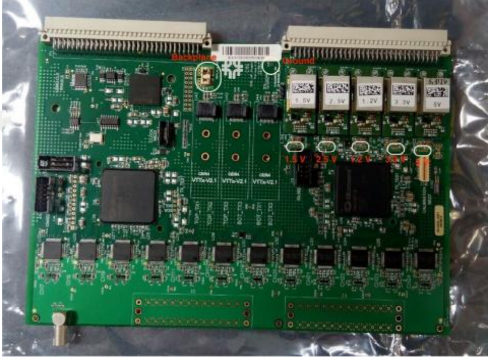
Şekil 4.5. DC/DC dönüştürücüleri, Zemin Düzlemi ve Arka Yüz giriş gücü
