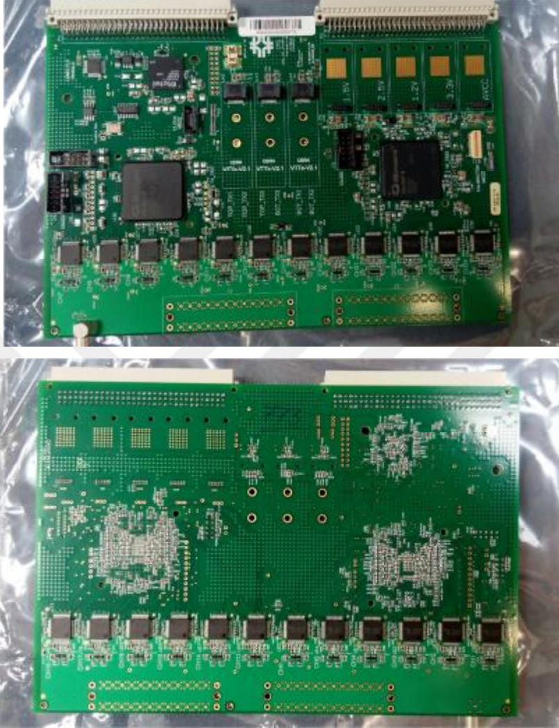
Şekil 4.4. Montajı tamamlanmamış QIE10 kartının ön ve arka yüzü
