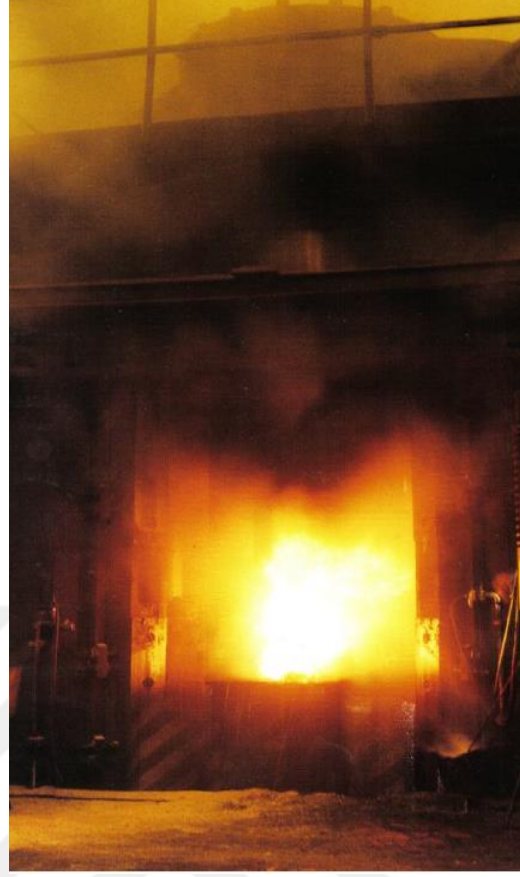
Şekil 4.14: DG-40 karşı vuruşlu çekiç - dövülme anı.
