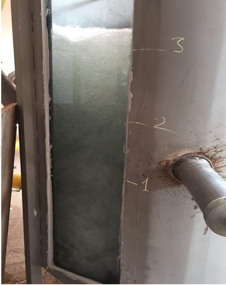
Şekil 3.1.10. R=0.92 m, h=50 cm, \alpha=60^\circ alternatifi ve kabarcık görünümü
