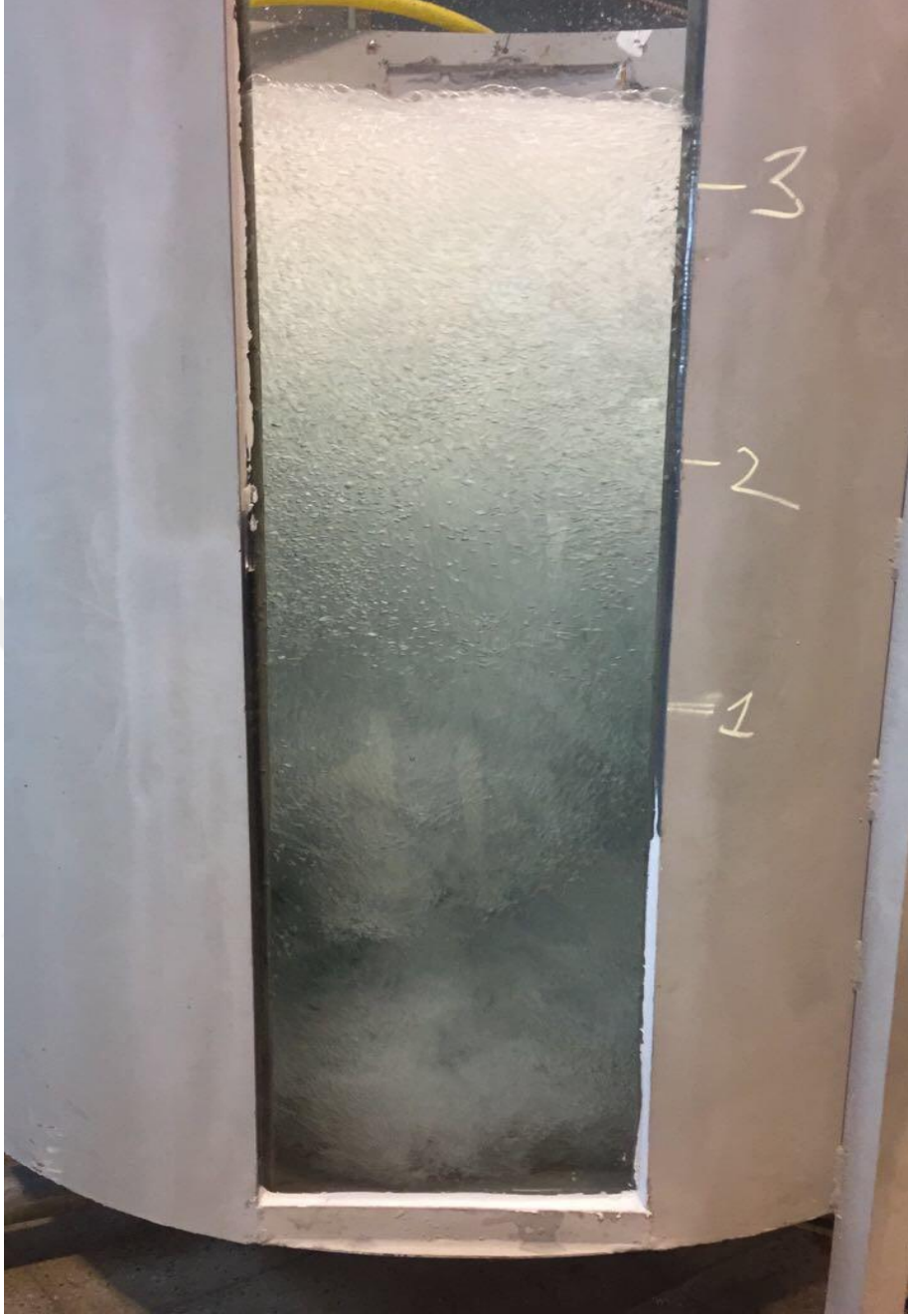
Şekil 3.1.11. R=1.30 m, h=50 cm, \alpha=60^\circ alternatifi ve kabarcık görünümü
