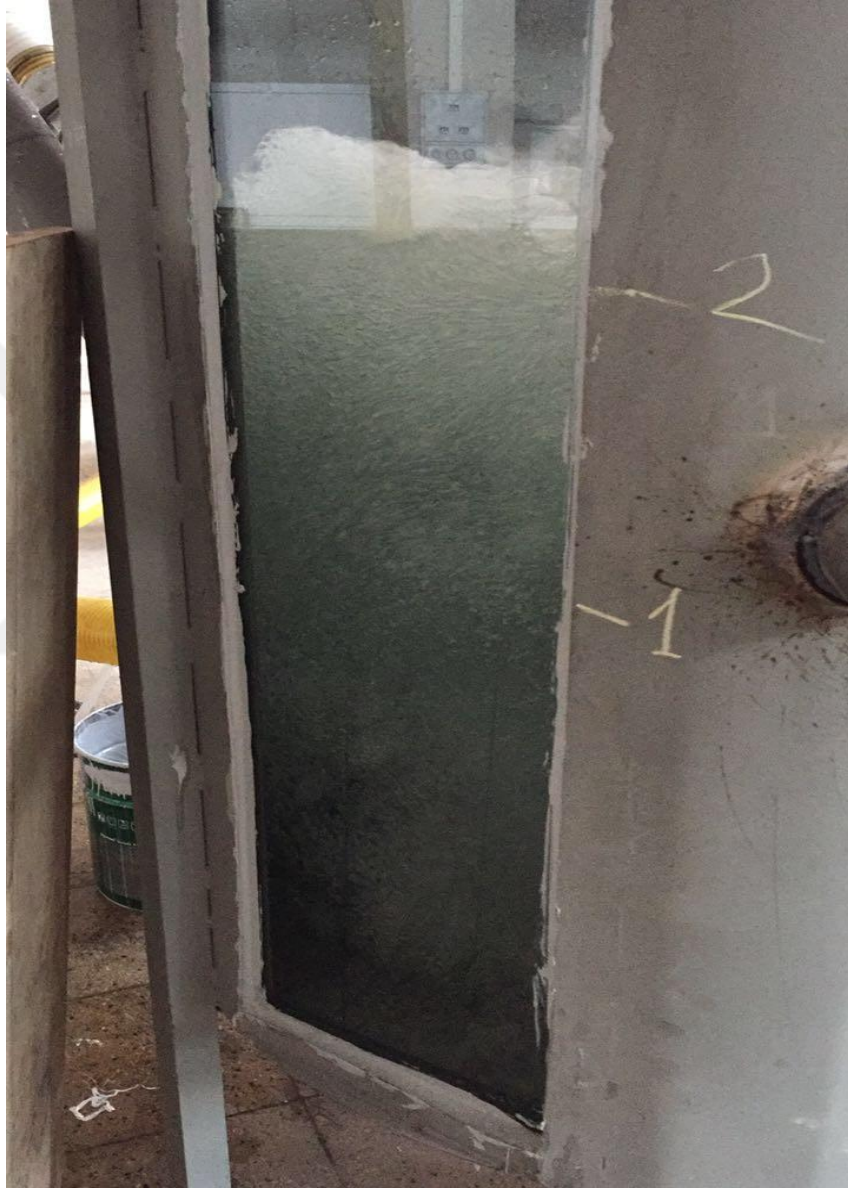
Şekil 3.3.11. R=0.92 m, \alpha=45^\circ , h=25 cm alternatifi ve kabarcık görünümü
