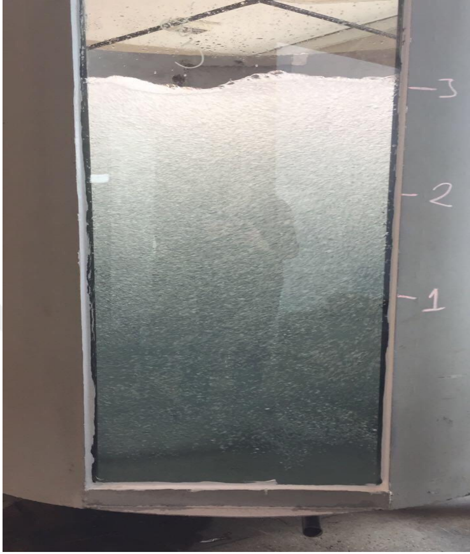
Şekil 3.2.10. R=1.60 m, h=50 cm, \alpha=60^\circ alternatifi ve kabarcık görünümü
