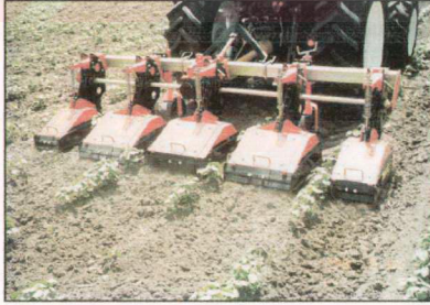
Şekil 12 : Frezeli araççapa makinası (Sönmezler)
