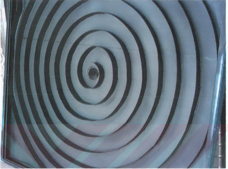
Şekil 5.10 Kollektörlerin iç yüzeyindeki spiral kanallar
