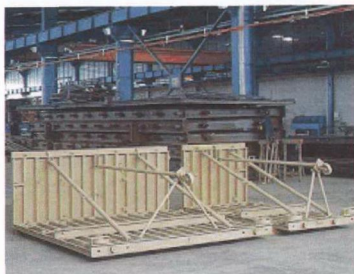
c) tekerlekli dikme ve çapraz destek elemanlarının montajı
