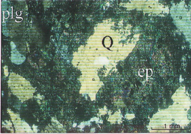
Şekil 3.49. Epidot-Piroksen skarlara ait bir örneğin mikroskoptaki görünümü. Epidotlar çoğunlukla piroksenlerin alterasyonu ile gelişmişlerdir. Örnek no: MS-6. (Ç.N, 10x3,2).
