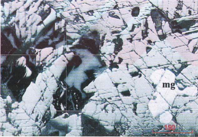
Şekil 5.8. Manyetitler (mg) ve manyetitlerin martitleşmesi ile oluşan hematitler . Örnek no: C. (T.N, 20x10).
