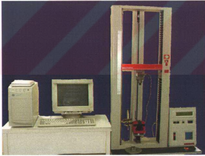
Resim 5.64. Universal test cihazı
