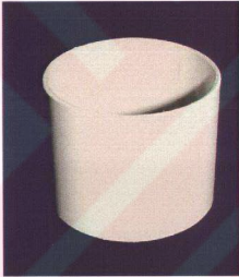
Resim 5.3. Akrilik bloklarda kullanılan kalıp
