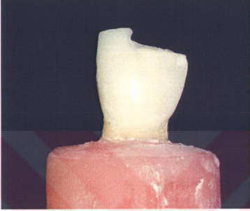
Resim 6.1. 2mm-Dentin grubunda gözlenen kırık
