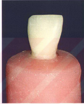
Resim 5.10. Akrilik blok içine yerleştirilen diş
