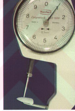
Resim 5.38. Porselen kalınlığının ölçülmesi
