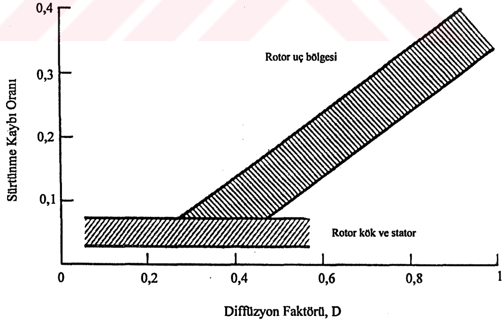
Şekil 4.9 Sürtünme kaybının diffüzyon oranı ile değişimi [9]
